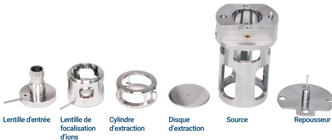
Figure 80. Pièces de la source CI à nettoyer
