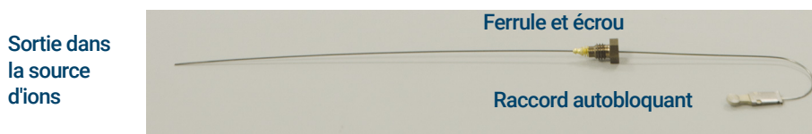
Figure 15. Extrémité du GC/MS 9000 retirée de l'interface GC/MS
