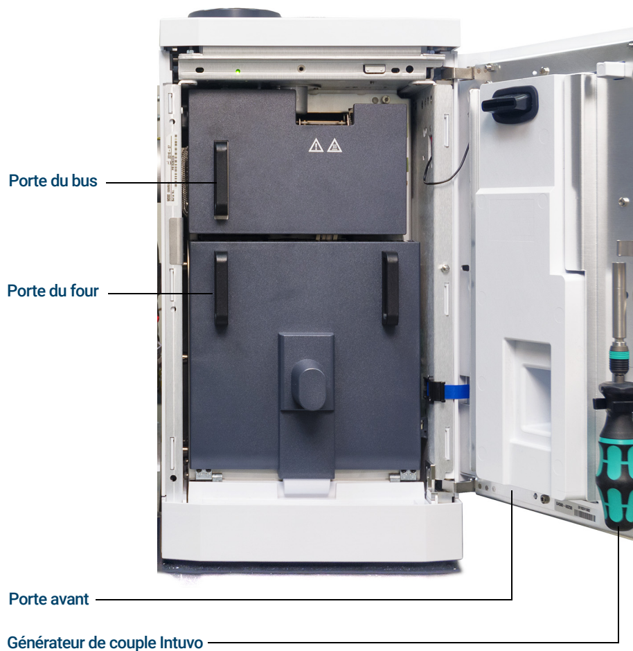
Figure 9. Porte-avant, porte du bus, porte du four et générateur de couple Intuvo du GC 9000
