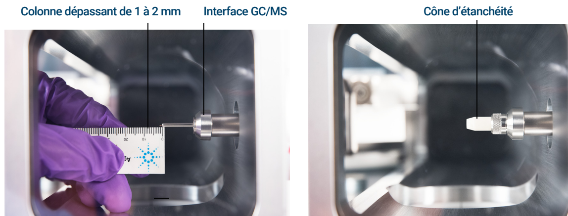
Figure 4. Installation d'une colonne capillaire dans l'interface GC/MS pour une source EI XTR ou une source CI
