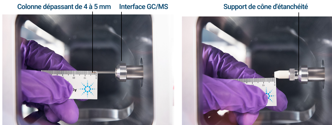
Figure 5. Installation d'une colonne capillaire dans l'interface GC/MS pour une source EI HES
