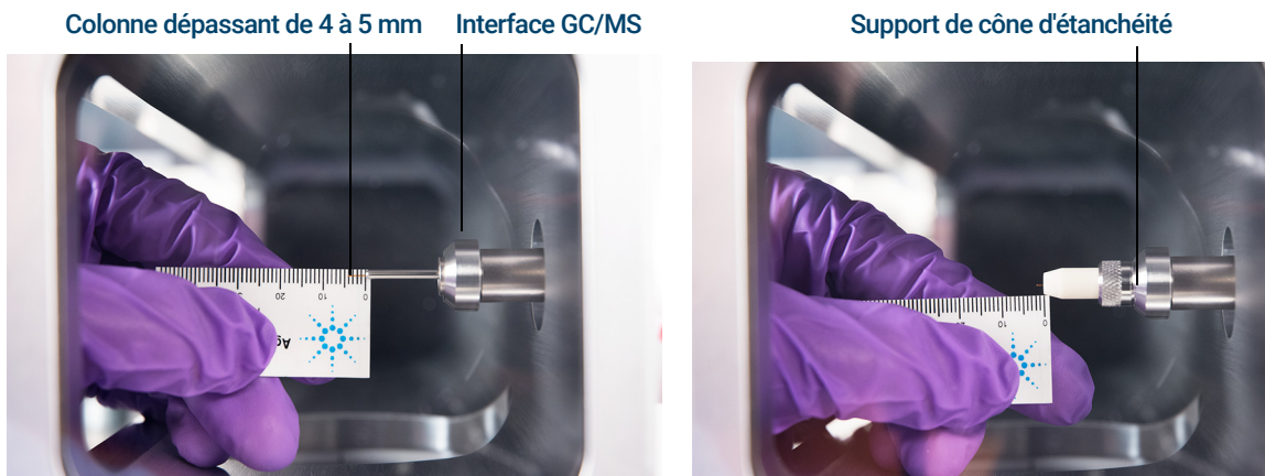
Figure 21. Installation d'une colonne capillaire dans l'interface GC/MS pour une source EI HES
