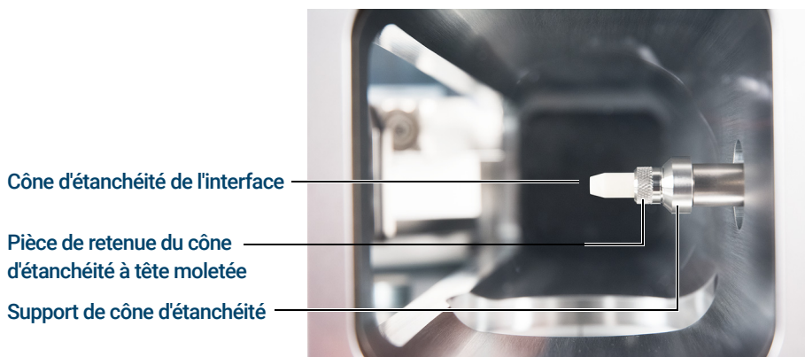
Figure 7. Cône d'étanchéité de l'interface GC/MS
