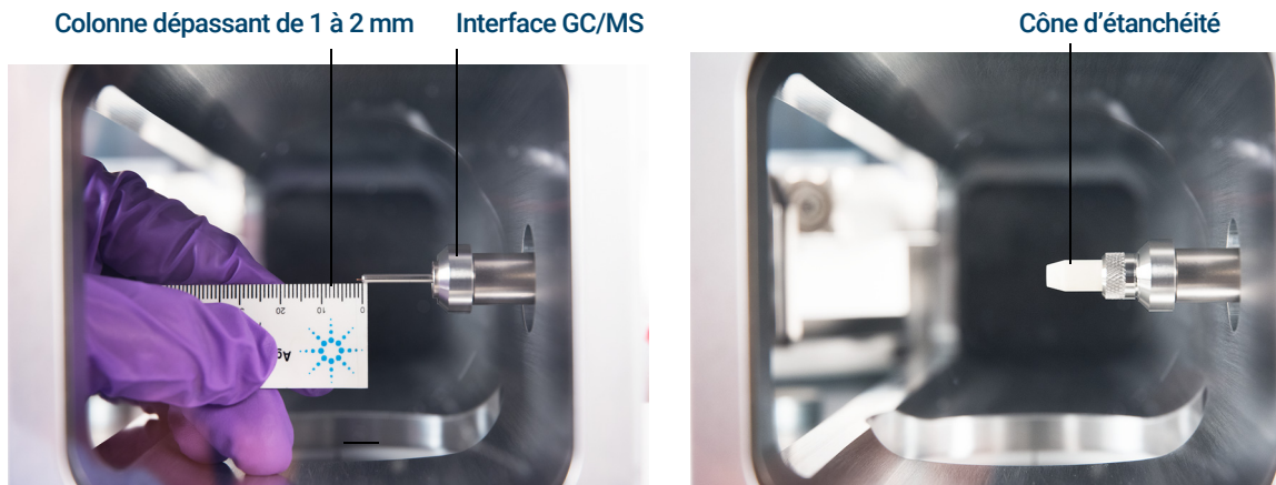
Figure 20. Installation d'une colonne capillaire dans l'interface GC/MS pour une source EI XTR ou une source CI
