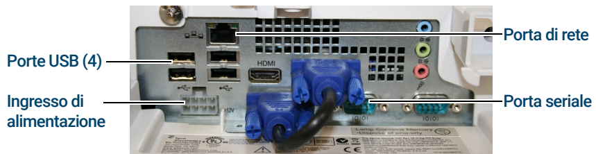
Figura 3. Porte dell'unità di controllo (lato inferiore)
