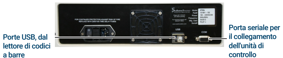
Figura 4. Pannello posteriore del dispositivo XFe: porte USB e porta seriale
