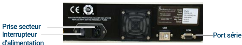
Figure 5. Panneau arrière du XFe – Prise d'alimentation secteur, interrupteur d'alimentation et port série
