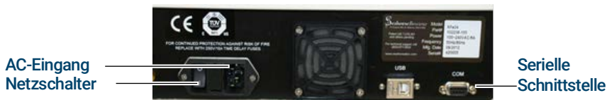
Abbildung 5. Rückseite des XFe – AC-Eingang, Netzschalter und serielle Schnittstelle
