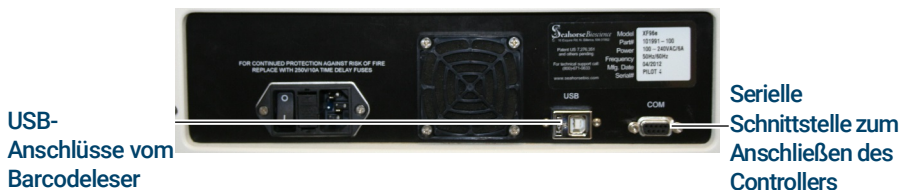
Abbildung 4. Rückseite des XFe – USB-Anschlüsse und serielle Schnittstellen
