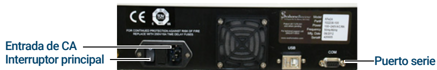
Figura 5. Panel trasero del analizador XFe: entrada de CA, interruptor principal y puerto serie.
