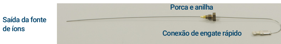
Figura 17. Extremidade terminal (Tail) do GC/MS 9000 removida da interface de GC/MSD
