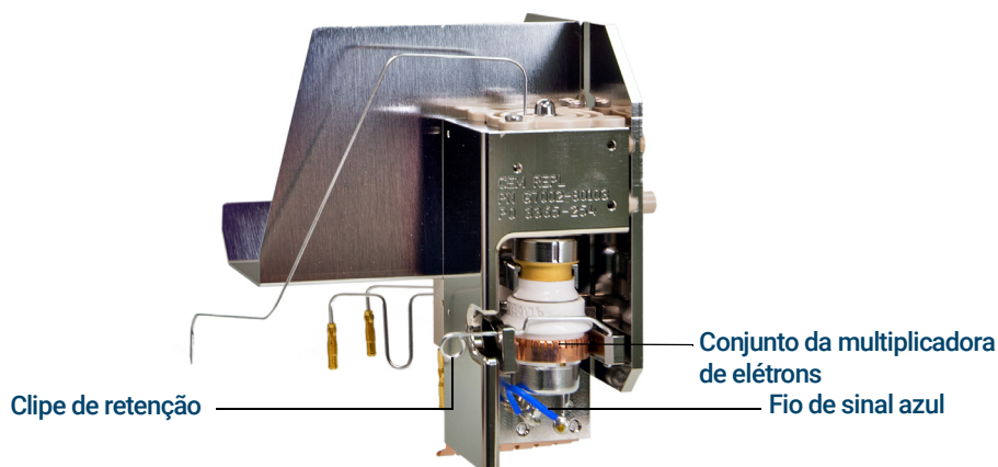
Figura 69. Substituição do conjunto da multiplicadora de elétrons em um detector da série 2
