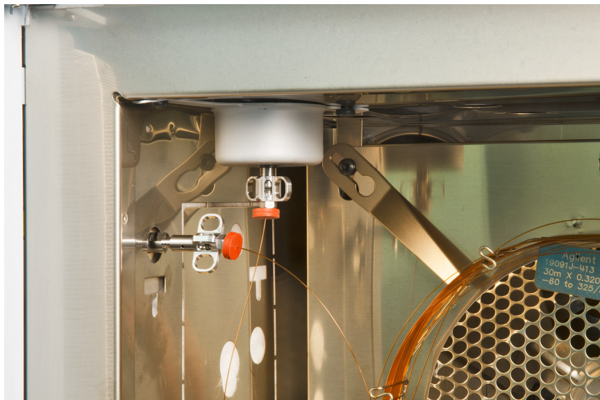
Figura 7. Instalação de uma coluna capilar na interface de GC/MSD
