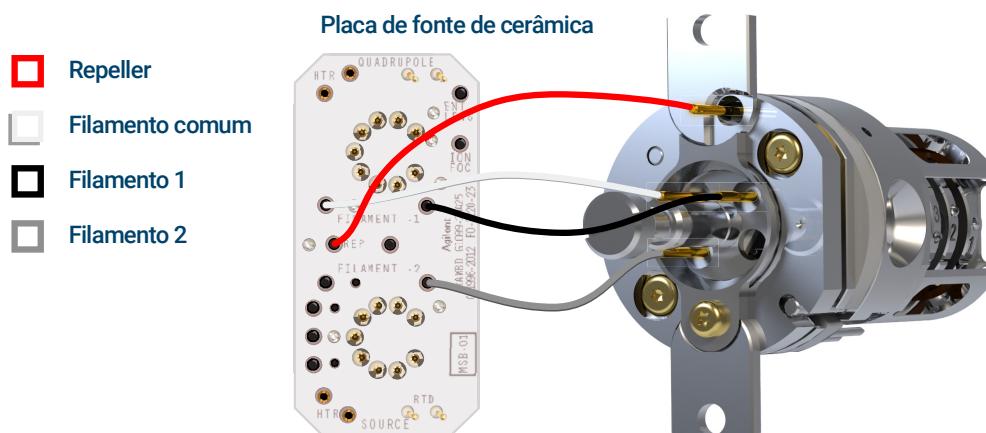
Figura 50 Fiação a ser conectada/desconectada durante a instalação ou remoção da fonte.
