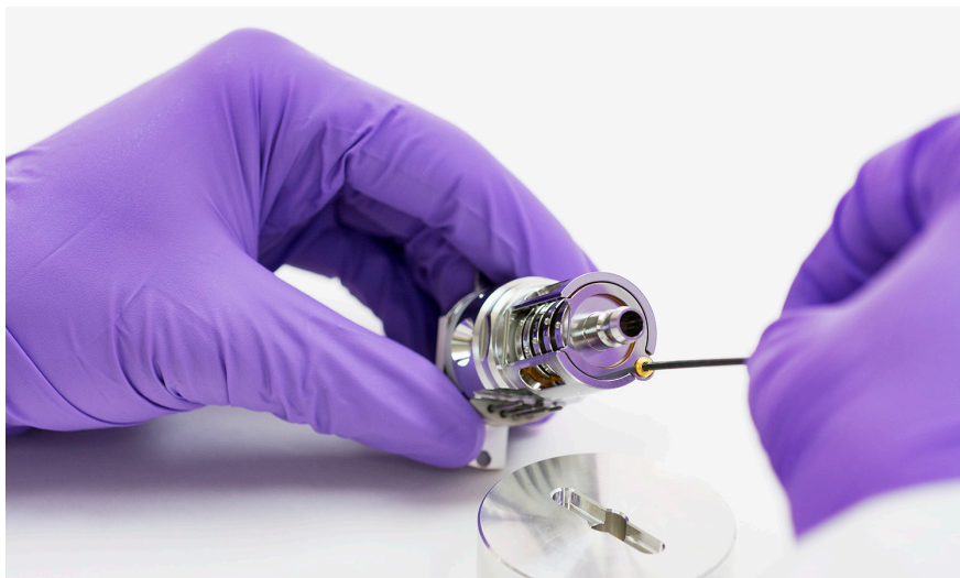
Figura 54 Fixe o parafuso da lente e bloqueie o anel isolante
