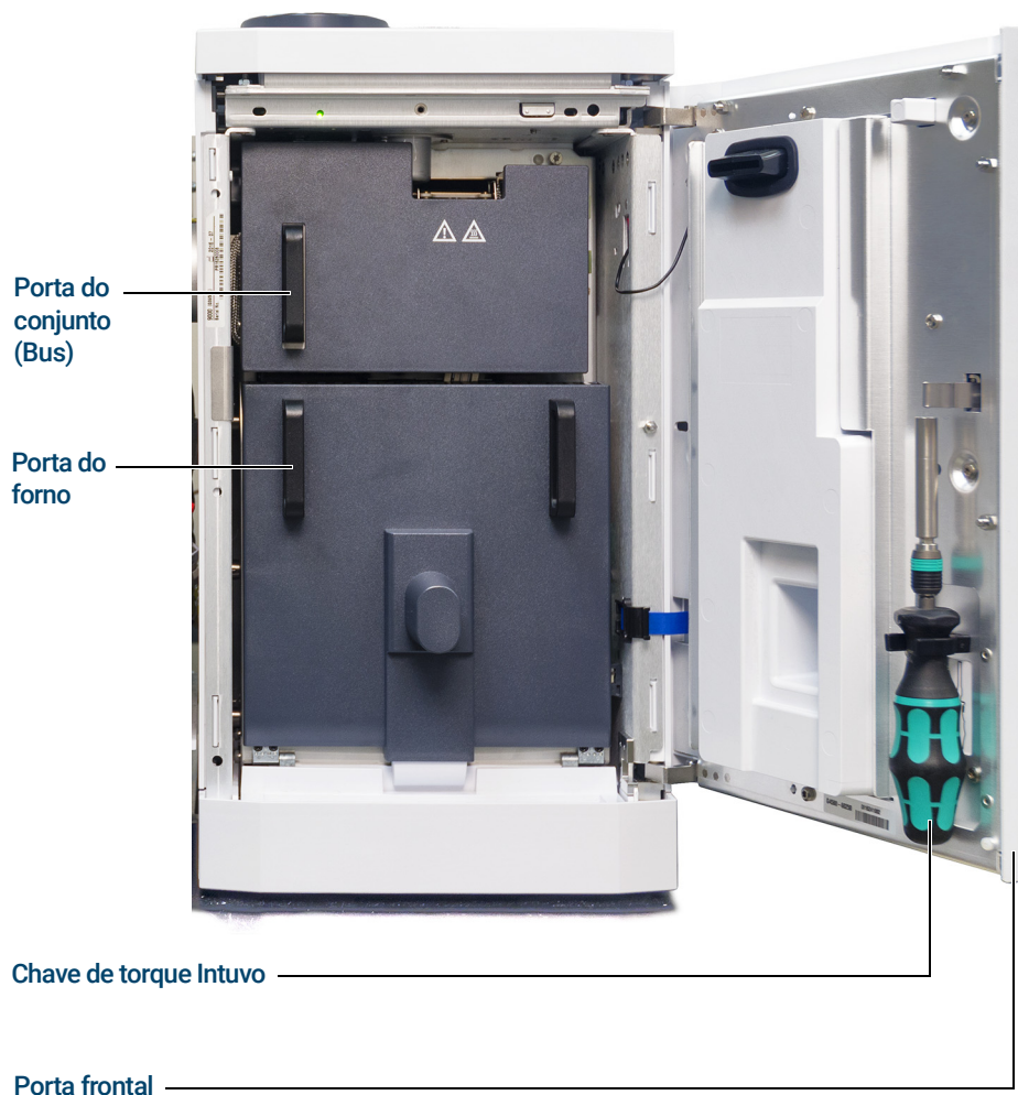
Figura 11. Porta frontal, porta do conjunto (Bus), porta do forno e torquímetro do Intuvo do GC 9000
