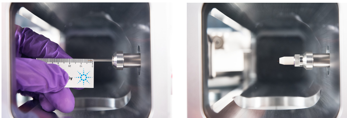
图 6. 将毛细管柱安装在 EI HES 离子源的 GC/MSD 接口中。
