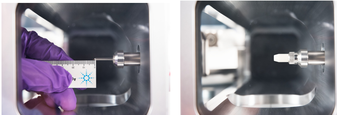
图 5. 将毛细管柱安装在 EI EXT、SS、惰性或 CI 离子源的 GC/MSD 接口中。
