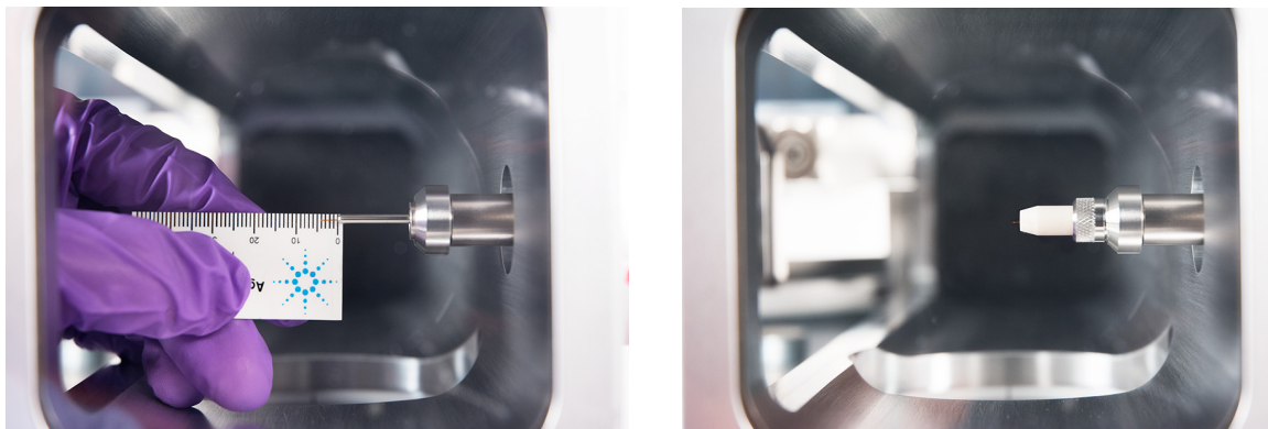
図 6. EI HES イオン源の場合の、GC/MSD インターフェイスへのキャピラリカラムの取り付け
