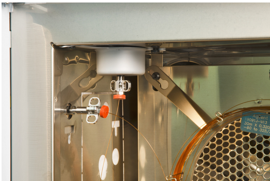
図 7. GC/MSD インターフェイスへのキャピラリカラムの取り付け
