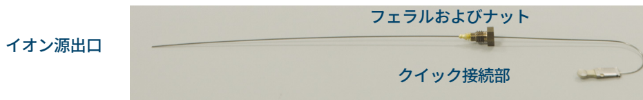
図 17. GC/MSD インターフェイスから取り外した 9000 GC/MS Tail
