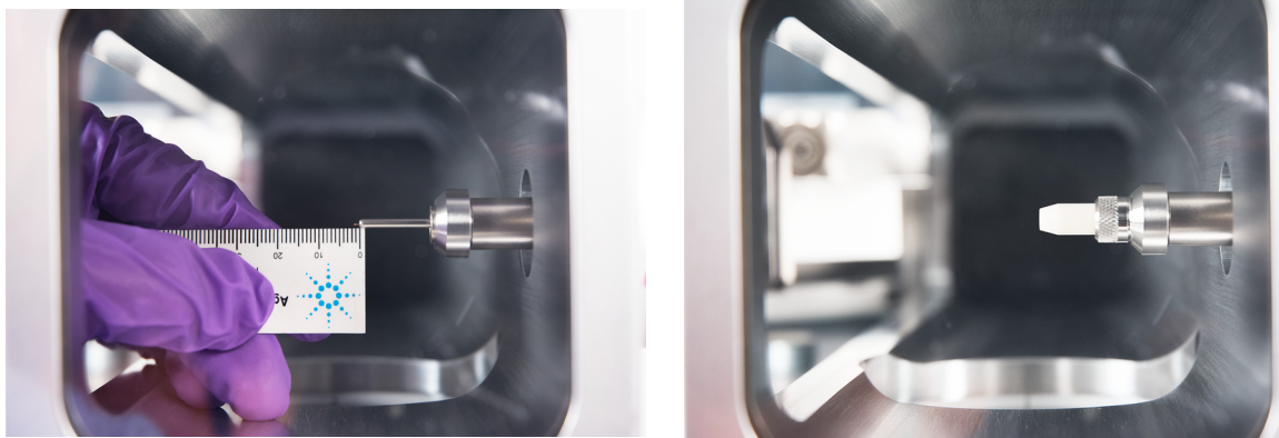
図 5. エクストラクタ EI、ステンレス製 EI、不活性 EI、または CI イオン源の場合の、GC/MSD インターフェイスへのキャピラリカラムの取り付け
