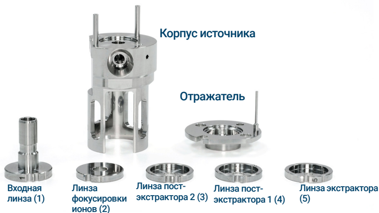
Рис. 52 Детали источника ЭУ HES, подлежащие очистке
