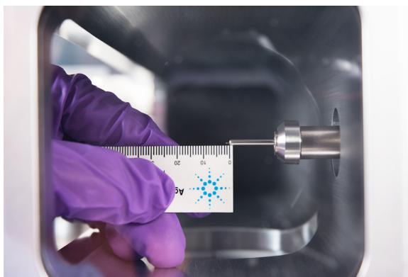
Рис. 5. Установка капиллярной колонки в интерфейс GX-МСД для источника ЭУ XTR, SS, инертного источника или источника ХИ
