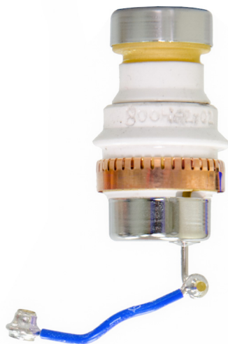
Figura 67. Conjunto da multiplicadora de elétrons
