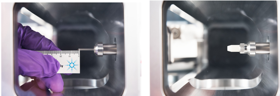
Figura 5. Instalação de uma coluna capilar na interface de GC/MSD em uma fonte EI EXT, SS, Inerte ou CI
