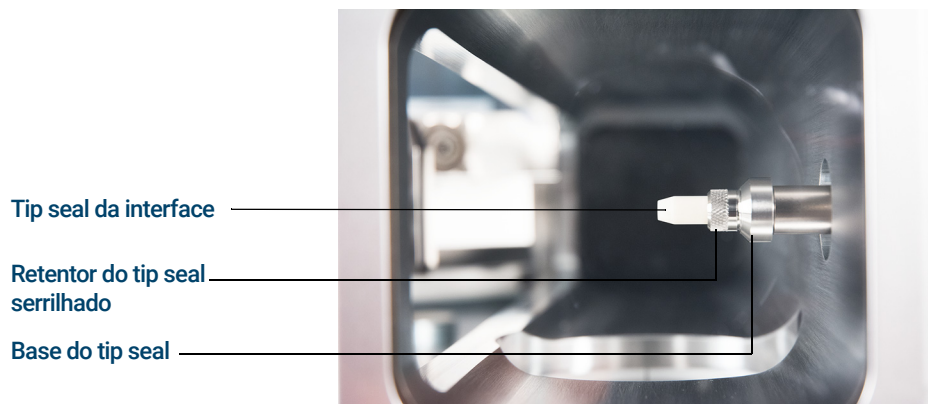
Figura 17. Tip seal da interface de GC/MSD
