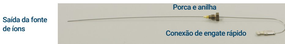
Figura 16. Extremidade terminal (Tail) do GC/MS 9000 removida da interface de GC/MSD
