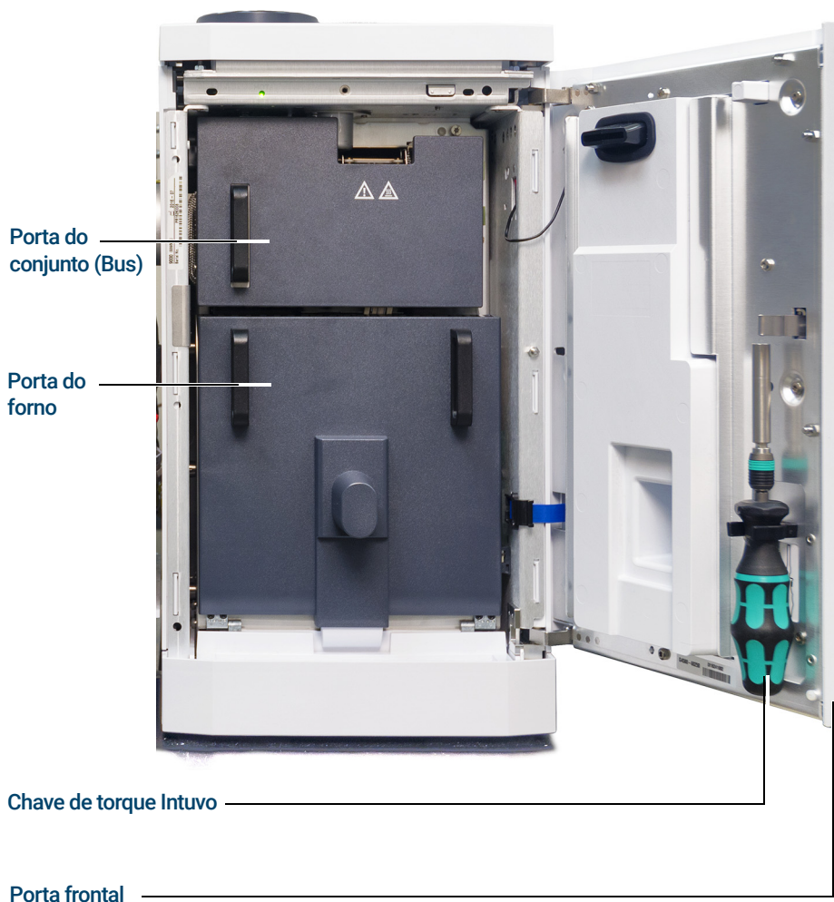
Figura 10. Porta frontal, porta do conjunto (Bus), porta do forno e torquímetro do Intuvo do GC 9000
