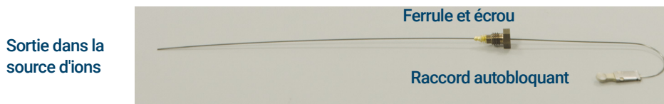
Figure 16. Extrémité du GC/MS 9000 retirée de l'interface GC/MSD
