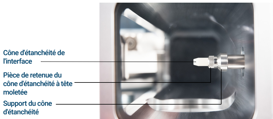
Figure 17. Cône d'étanchéité de l'interface GC/MSD
