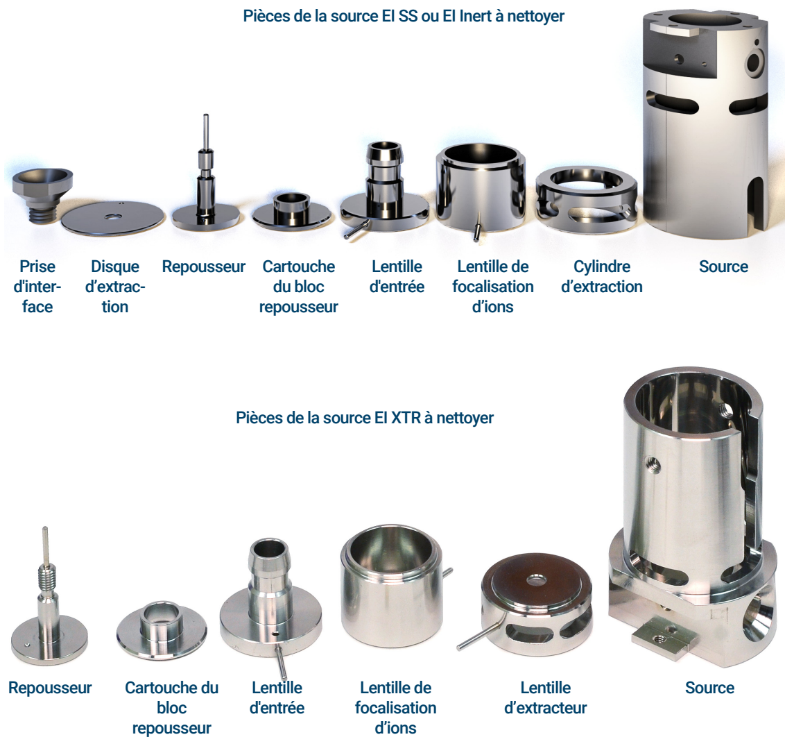
Figure 59. Pièces de la source à nettoyer
