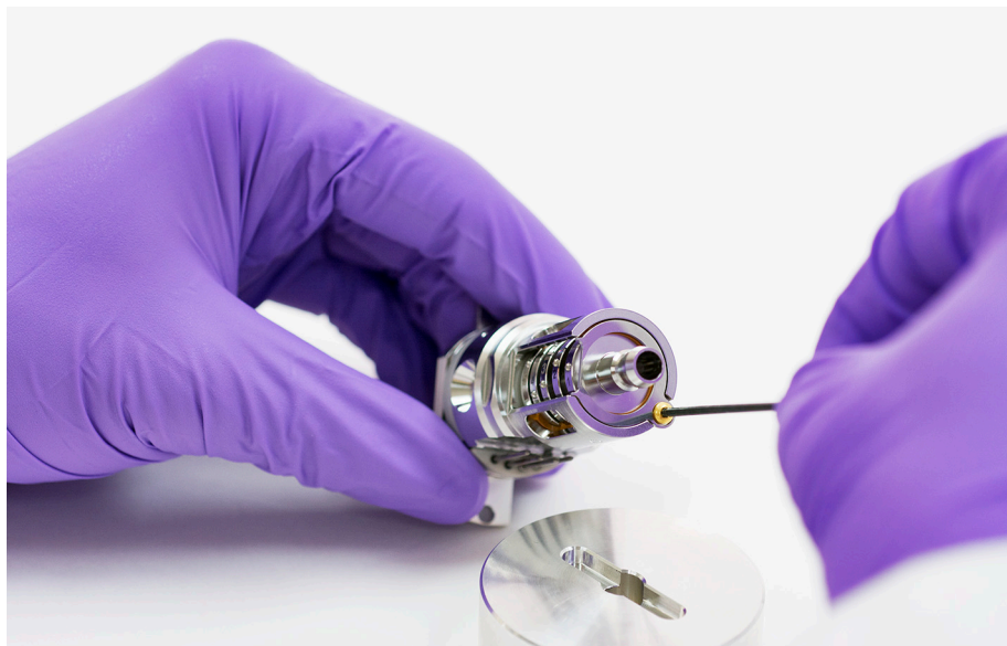
Figure 51. Fixer la vis de la lentille et l'isolant de l'anneau de verrouillage.
