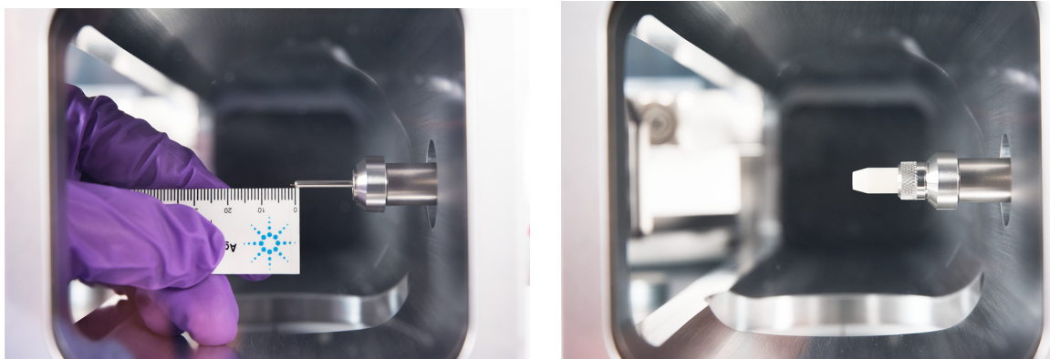
Figure 5. Installation d'une colonne capillaire dans l'interface GC/MSD pour une source EI EXT, SS, Inert ou CI.
