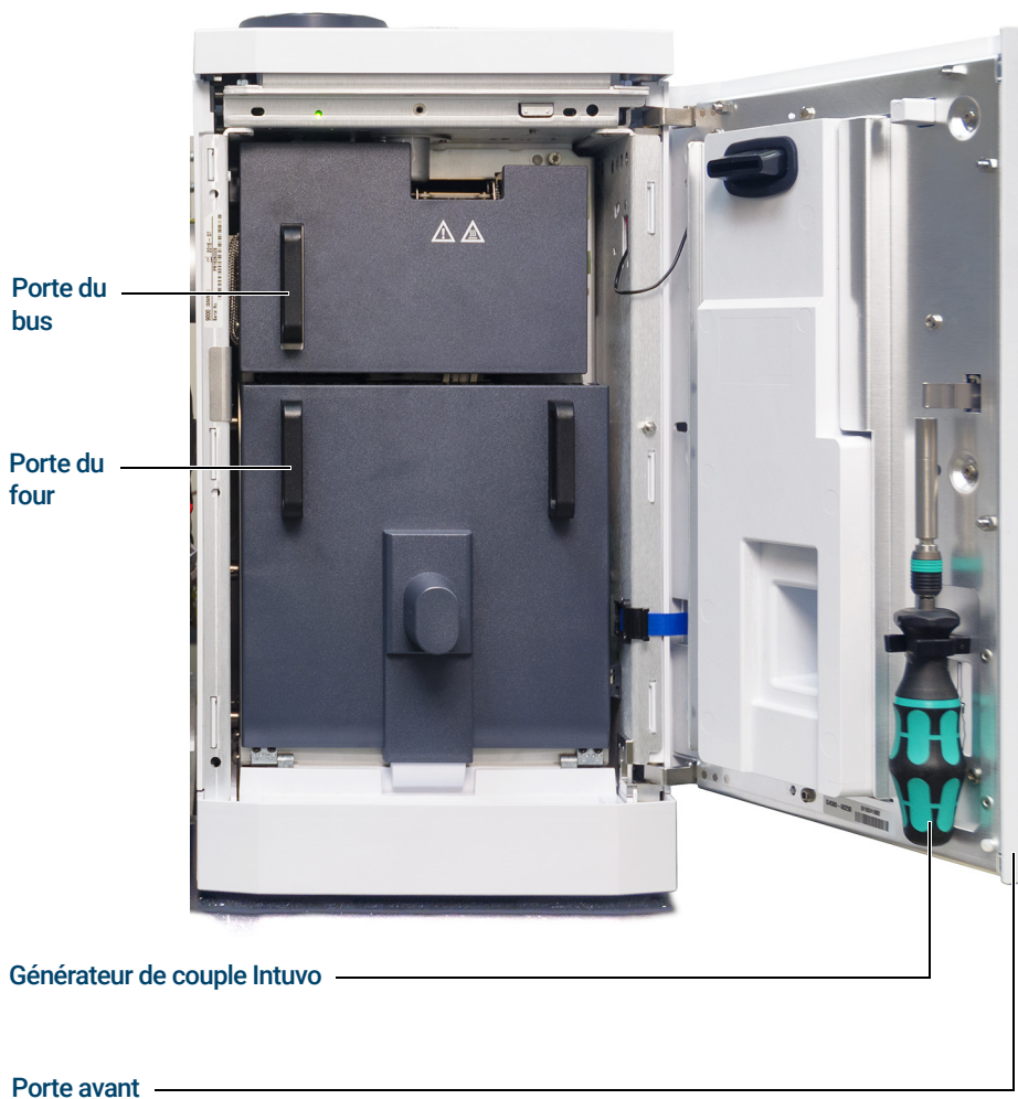
Figure 10. Porte-avant, porte du bus, porte du four et générateur de couple Intuvo du GC 9000
