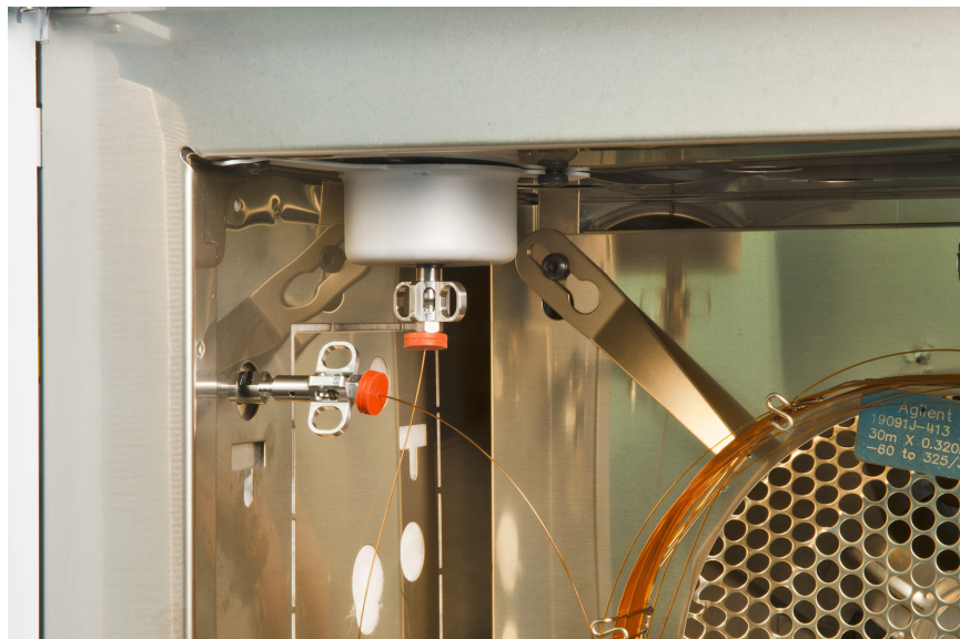
Figure 7. Installation d'une colonne capillaire dans l'interface GC/MSD
