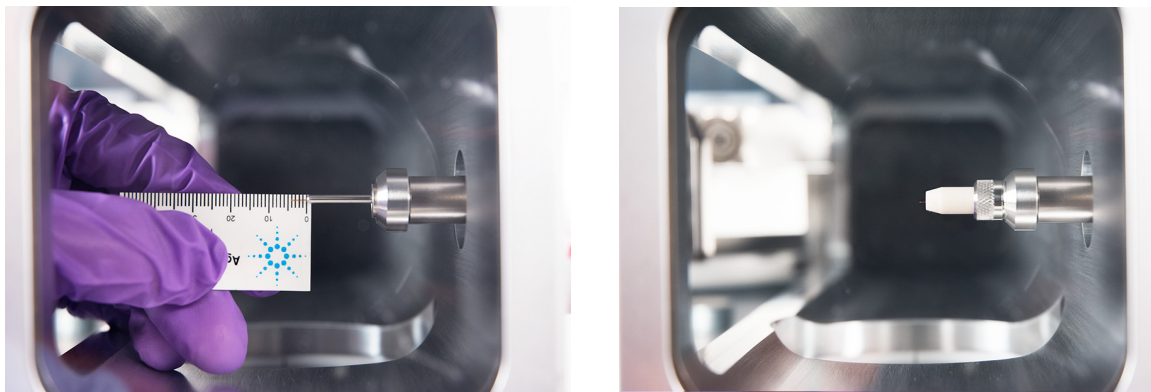
Figure 6. Installation d'une colonne capillaire dans l'interface GC/MSD pour une source EI HES.
