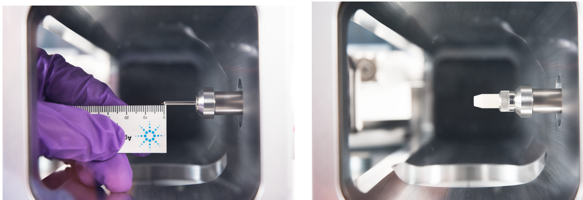
그림 5. EI XTR, SS, 비활성 또는 CI 소스용 GC/MSD 인터페이스에 캐필러리 컬럼 설치
