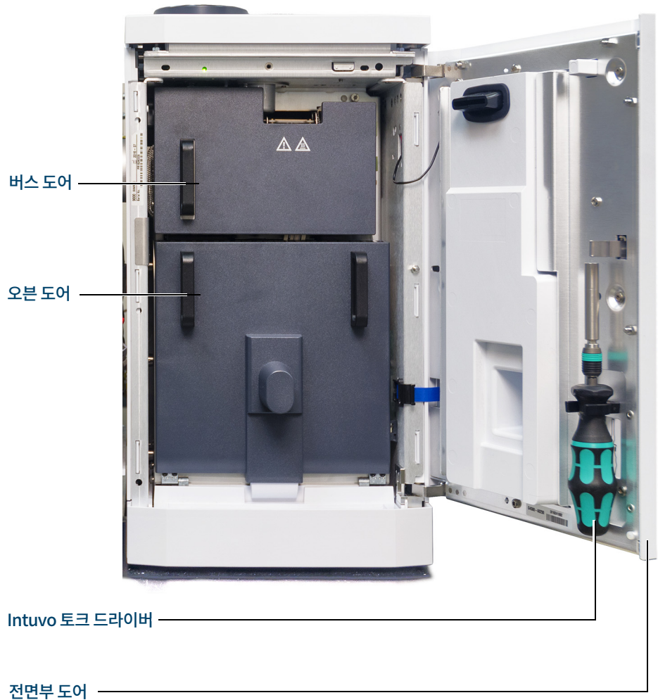
그림 10. 9000 GC 전면부 도어, 버스 도어, 오븐 도어, Intuvo 토크 드라이버
