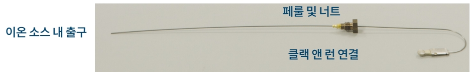
그림 16. GC/MSD 인터페이스에서 제거된 9000 GC/MS 테일
