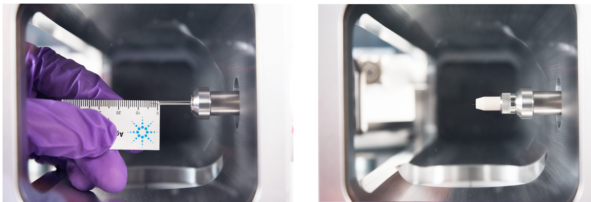
그림 6. EI HES용 GC/MSD 인터페이스에 캐필러리 컬럼 설치
