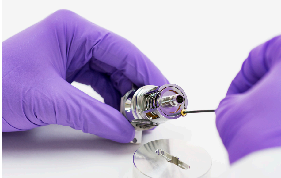
그림 60 렌즈 나사 고정 및 잠금 링 절연체의 고정
