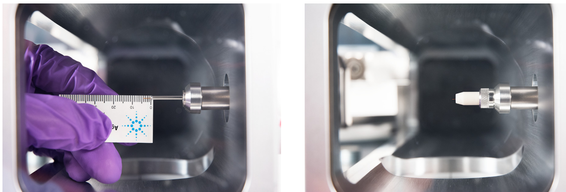
그림 22. EI HES용 GC/MSD 인터페이스에 캐필러리 컬럼 설치
