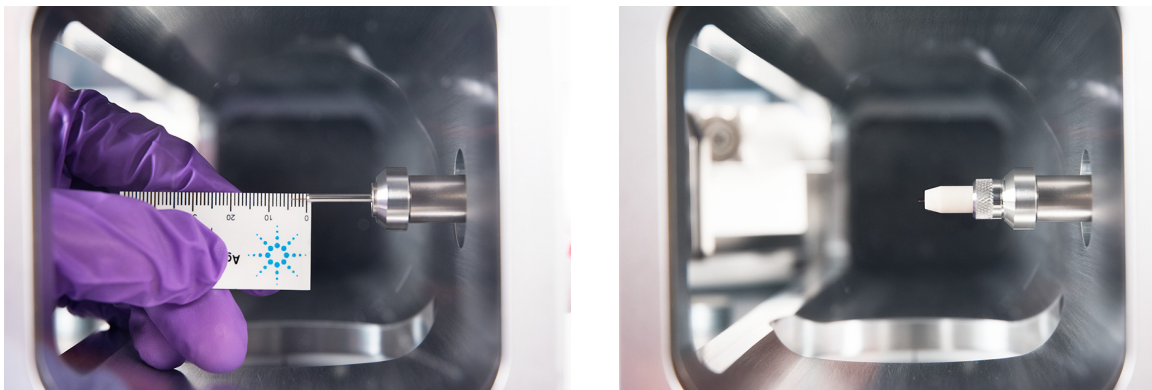
Figure 22. Installation d'une colonne capillaire dans l'interface GC/MSD pour une source EI HES.
