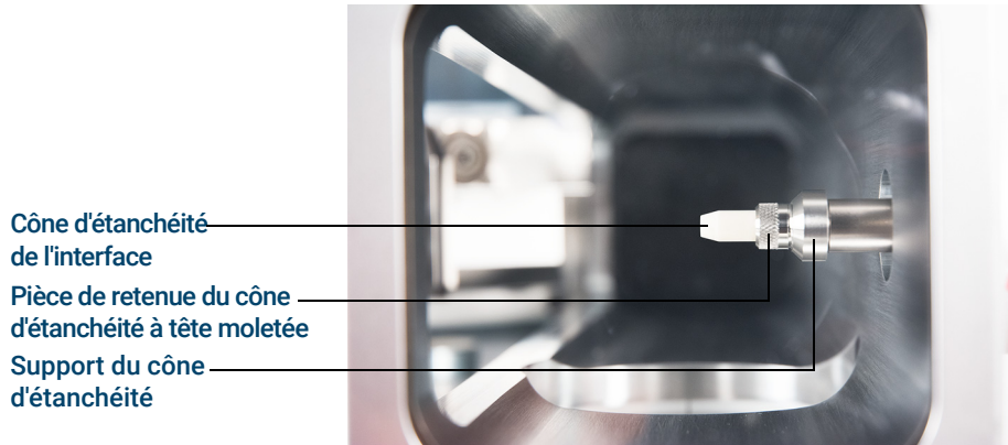
Figure 24. Cône d'étanchéité de l'interface GC/MSD
