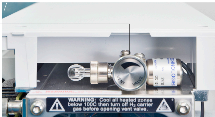
Figure 46 Vanne de mise à la pression atmosphérique
