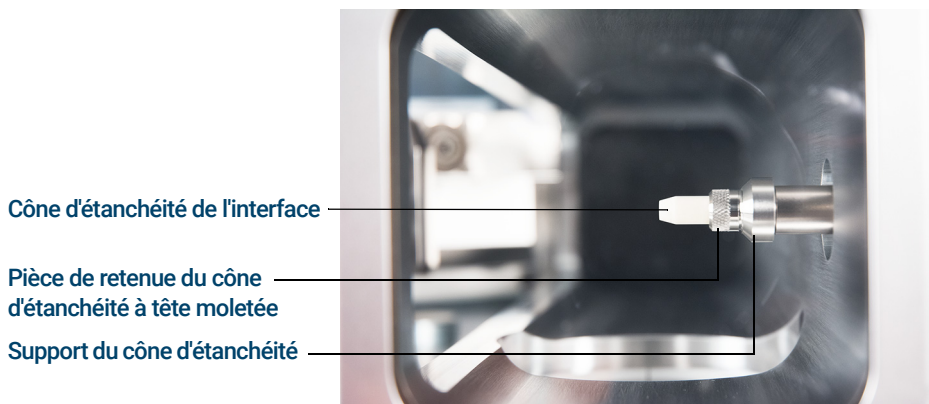
Figure 17. Cône d'étanchéité de l'interface GC/MSD
