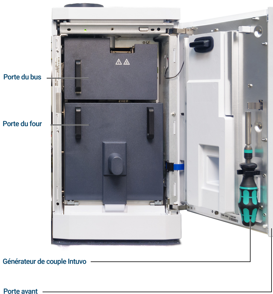
Figure 10. Porte-avant, porte du bus, porte du four et générateur de couple Intuvo du GC 9000
