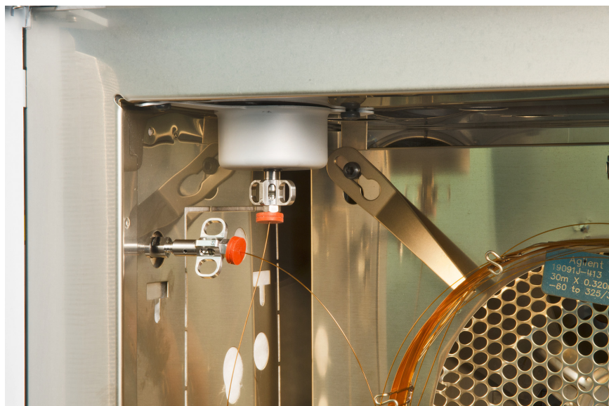
Figure 23. Installation d'une colonne capillaire dans l'interface GC/MSD
