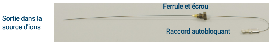
Figure 16. Extrémité du GC/MS 9000 retirée de l'interface GC/MSD
