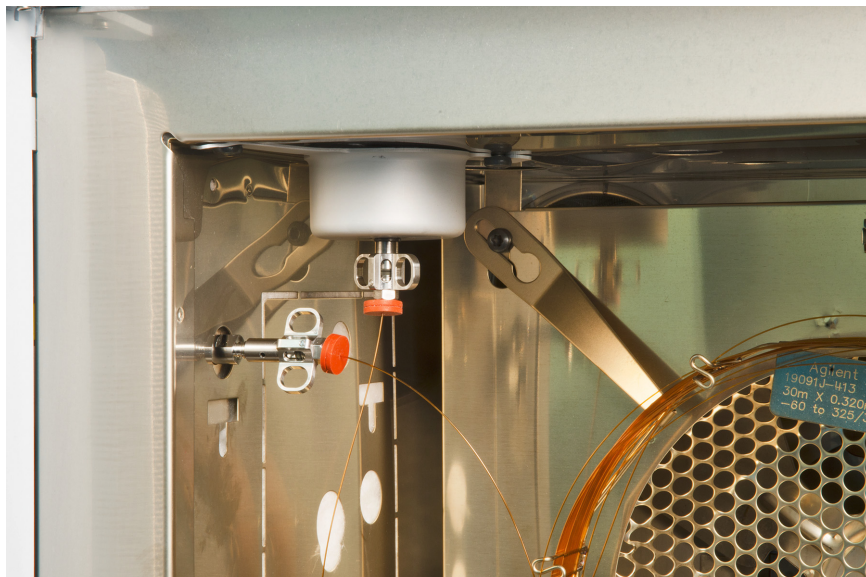
Figure 7. Installation d'une colonne capillaire dans l'interface GC/MSD
