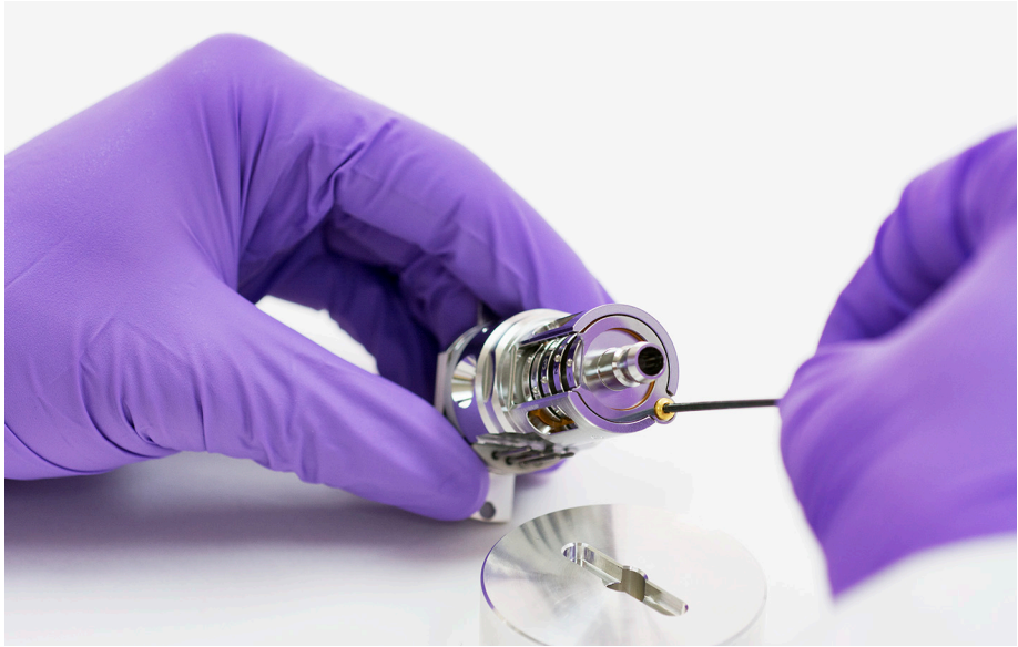
Figure 60. Fixer la vis de la lentille et l'isolant de l'anneau de verrouillage.
