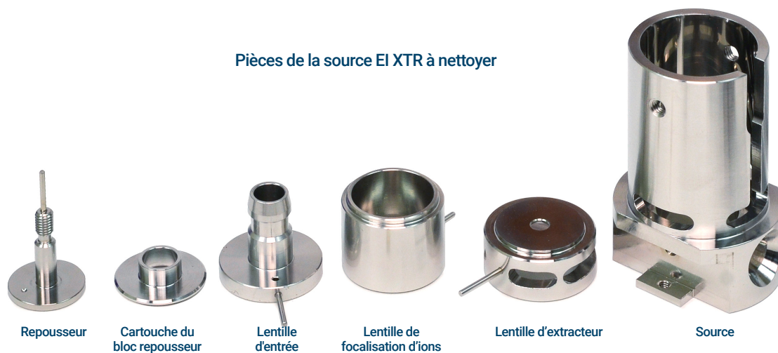
Figure 66. Pièces de la source à nettoyer
