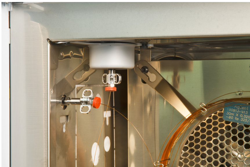
Abbildung 7. Installieren einer Kapillarsäule in das GC/MSD-Interface
