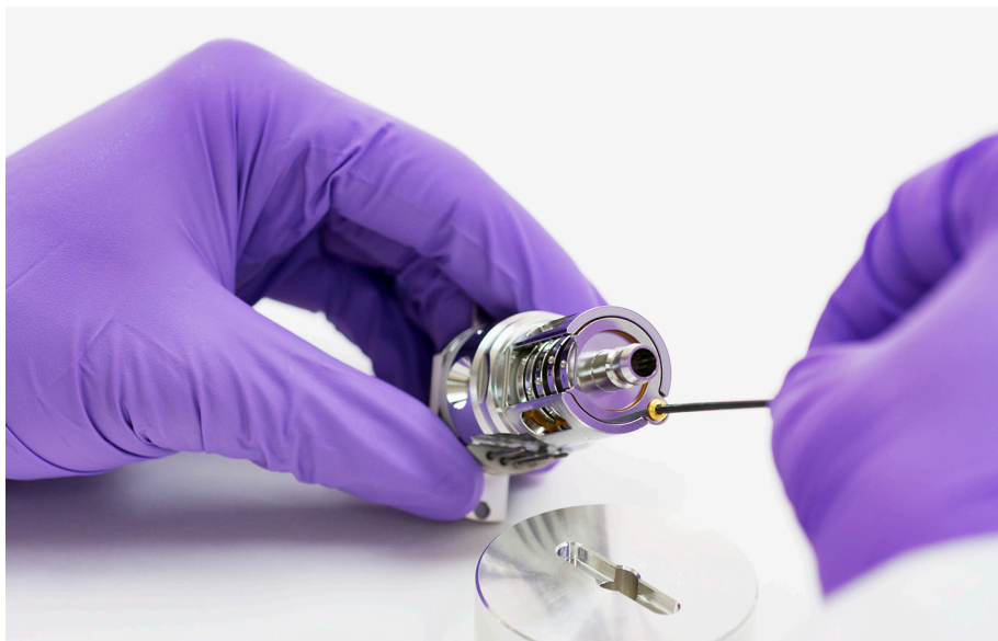
Abbildung 60. Befestigen Sie die Linsenschraube und den Verschlussring des Isolators.
