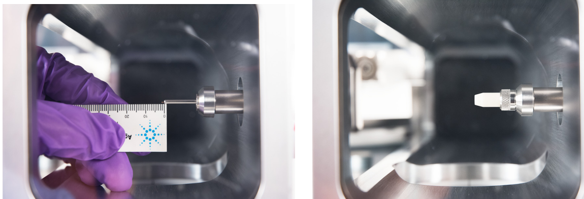
Abbildung 21. Installieren einer Kapillarsäule im GC/MSD-Interface für eine EI-XTR-, EI-Edelstahl-, Inert- oder CI-Quelle.
