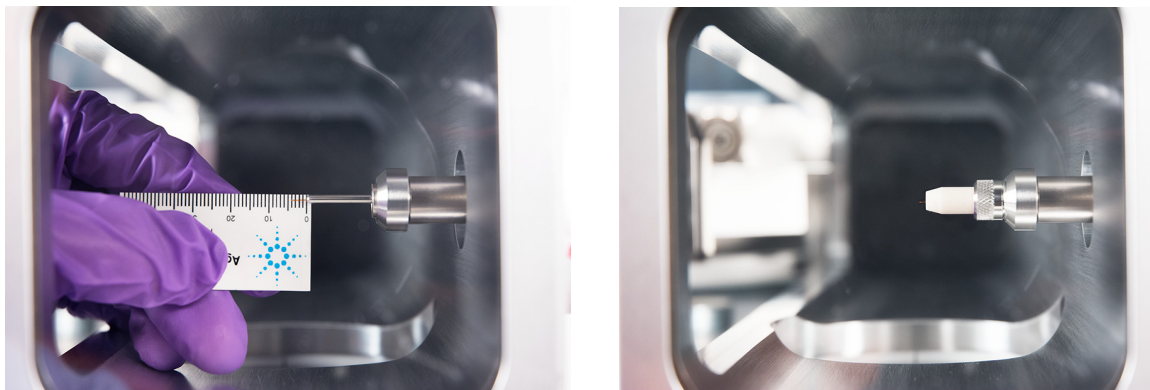
Abbildung 6. Installieren einer Kapillarsäule im GC/MSD-Interface für eine EI-HES-Quelle.
