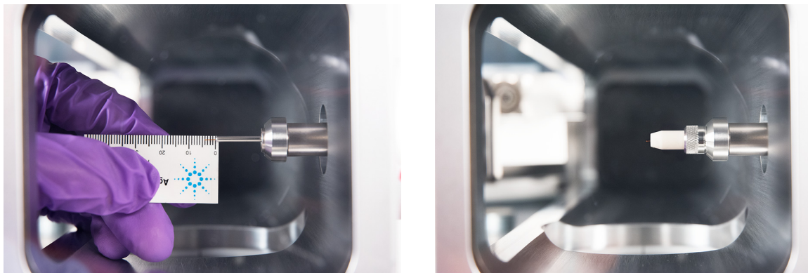
Abbildung 22. Installieren einer Kapillarsäule im GC/MSD-Interface für eine EI-HES-Quelle.
