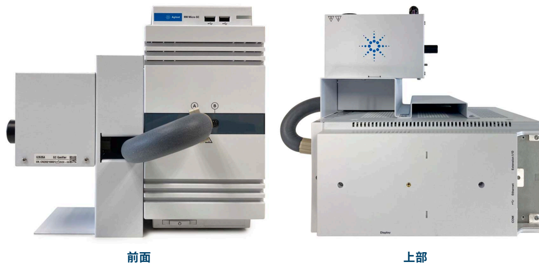
図 6. 990 Micro GC に接続されたトランスファライン
