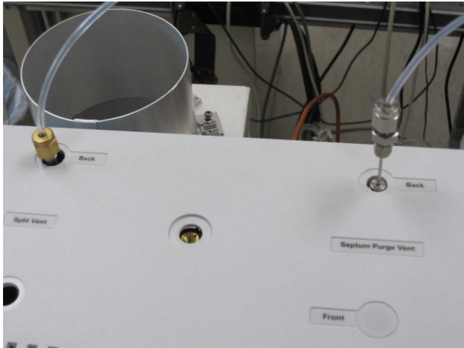
그림 2. 설치된 각 주입구의 분할 배기구와 셉타 퍼지 배기구는 음압 실험실 배기 시스템에 연결해야 합니다.
