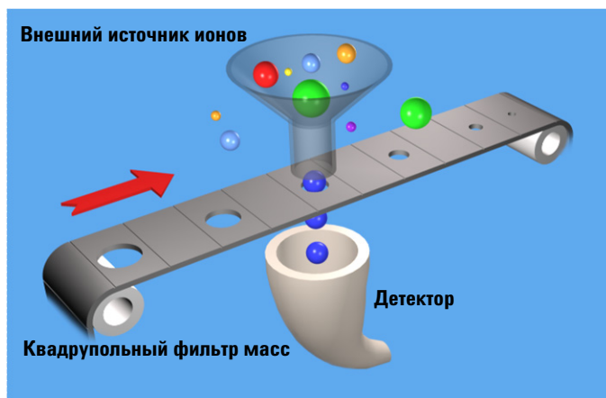
Рис. 2. Концептуальная модель масс-спектрометра с одиночным квадруполем
