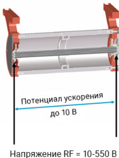
Рис. 22. Конструкция ячейки соударений
