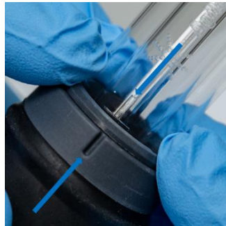
Figure 9 Alignez la rainure du corps de la torche avec le repère en « T » de l'ensemble de tubes externes
