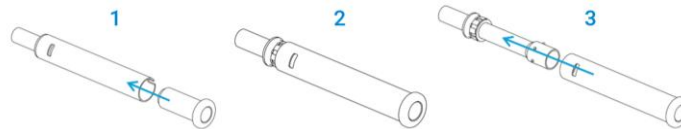
Abbildung 11 Darstellung der Zerlegung des Keramik-Außenrohrsets
