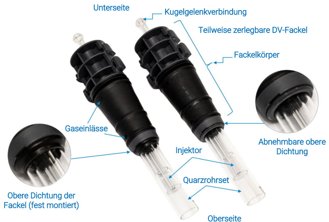
Abbildung 1 Darstellung der Teile der einteiligen und teilweise zerlegbaren Agilent Dual View (DV) ICP-OES Easy Fit Fackel. Die Radial View (RV) Fackel für die ICP-OES verwendet dieselbe Basis und Injektor-Einheit. Das Außenrohrset der RV ist kürzer und hat keinen Schlitz an der Oberseite des Außenrohrs
