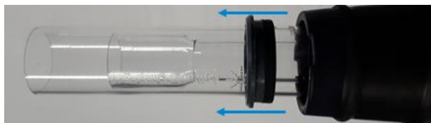
그림 8 외부 튜브 세트와 함께 상단 씰이 빠져나온 경우 씰을 토치 본체에서 밀어내어 제거
