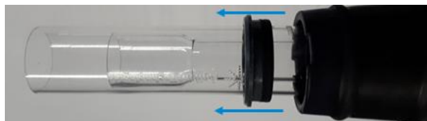
Figura 8 Se la guarnizione superiore fuoriesce insieme al set di tubi esterni, farla scorrere lontano dal corpo della torcia per rimuoverla
