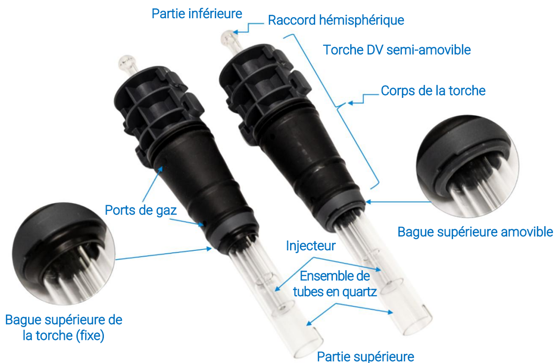
Figure 1 Pièces illustrées de la torche monobloc et semi-amovible Easy-fit pour ICP-OES à double visée (DV) Agilent. La torche à visée radiale (RV) pour ICP-OES possède la même base et le même ensemble injecteur. L'ensemble de tubes externes RV est plus court et ne comporte pas de fente au sommet du tube externe
