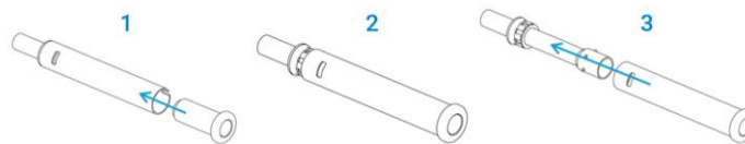
Figura 11. Ilustración que muestra el desmontaje del conjunto de tubos exterior de cerámica.
