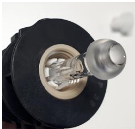
Abbildung 6 Durch den Fackelkörper eingesetzter Injektor
