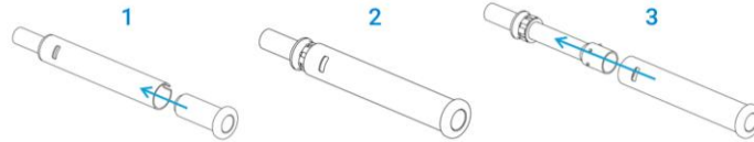
图 11 陶瓷外管组拆卸示意图
