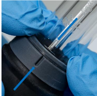
그림 9 토치 본체의 홈과 외부 튜브 세트의 "T" 표시 정렬
