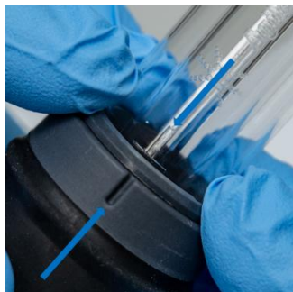
図9 トーチ本体の溝を外側チューブセットの「T」マークに合わせる
