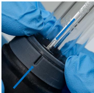
图 9 将炬管体凹槽与外管组上的“T”标记对准
