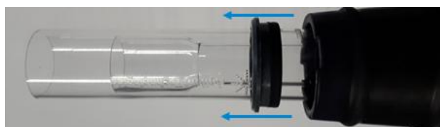
図8 トップシールが外側チューブセットと一緒に外れる場合は、シールをトーチ本体からスライドさせて取り外す
