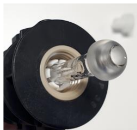
図 6 トーチ本体にインジェクタを挿入
