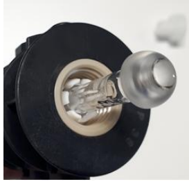
Figure 6 Injecteur inséré dans le corps de la torche
