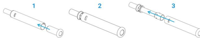
Figure 11 Vue illustrée présentant le démontage de l'ensemble de tubes externes en céramique
