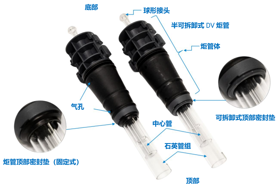
图 1 Agilent 双向观测 (DV) ICP-OES 一体式易安装炬管和半可拆卸式易安装炬管部件图解。用于 ICP-OES 的径向观测 (RV) 炬管具有相同的基座和中心管组件。RV 外管组长度更短，且外管顶部没有狭缝
