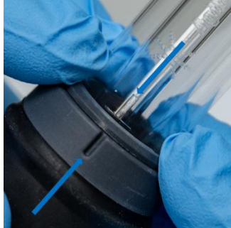
Abbildung 9 Einkerbung am Fackelkörper auf die „T“-Markierung auf dem Außenrohrset ausrichten
