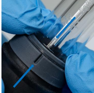
Figura 9 Allineare la scanalatura sul corpo della torcia con il contrassegno a T sul set di tubi esterni
