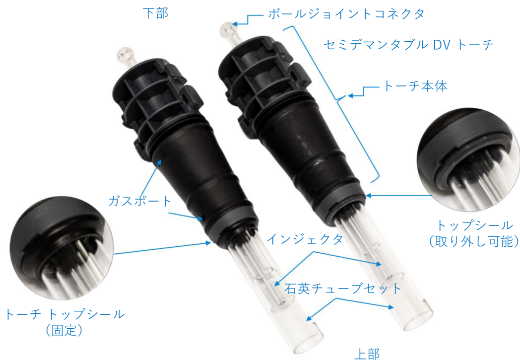
図 1 Agilent デュアルビュー (DV) ICP-OES Easy-fit 一体型およびセミデマンタブルトーチの部品 ICP-OES のラディアルビュー (RV) トーチには、同じベースとインジェクタアセンブリがあります。RV 外側チューブセットは長さが短く、外側チューブの上部に切り欠きがありません
