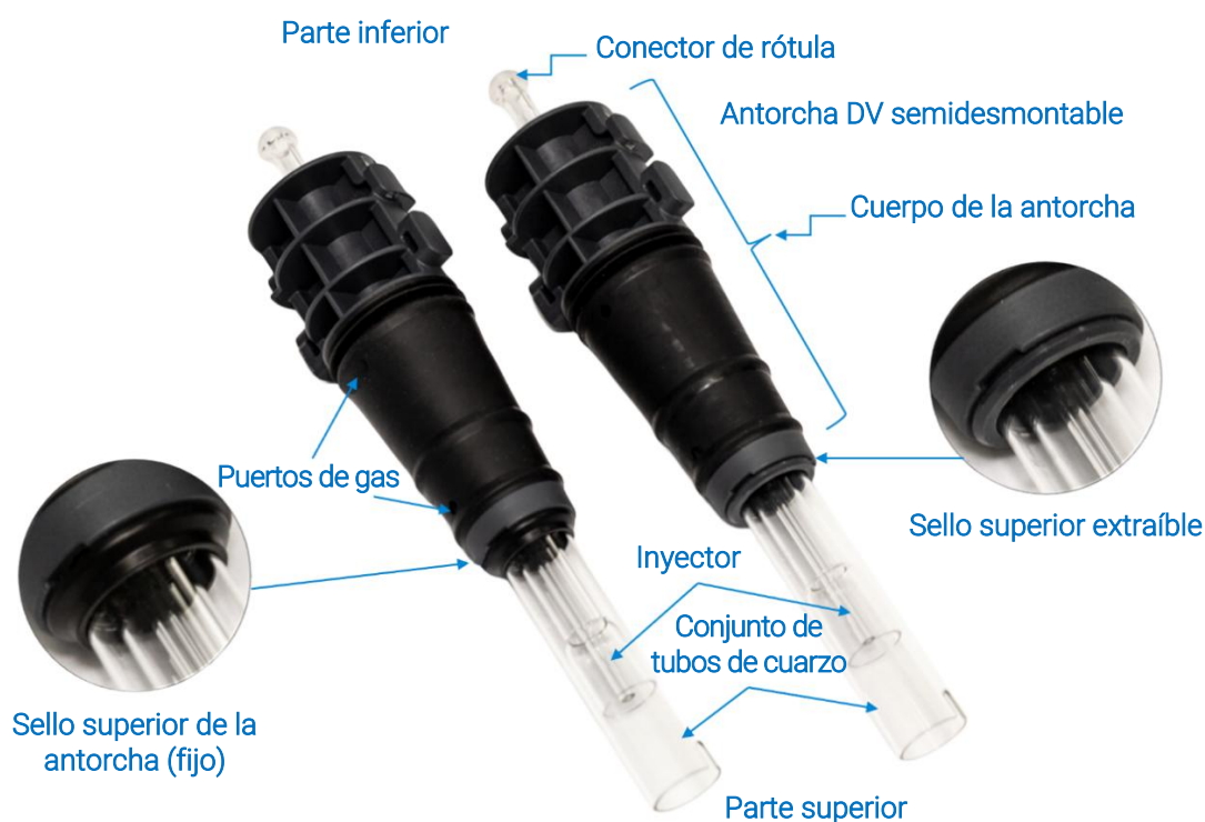
Figura 1. Ilustración de los componentes de las antorchas de montaje rápido de una sola pieza y semidesmontables para instrumentos de ICP-OES Dual View (DV) de Agilent. La antorcha para instrumentos de ICP-OES Radial View (RV) tiene el mismo conjunto de base e inyector. El conjunto de tubos exterior RV es de menor longitud y no tiene una ranura en la parte superior
