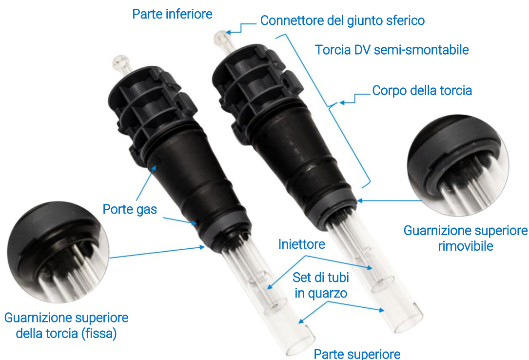
Figura 1 Illustrazione delle parti della torcia Agilent Dual View (DV) Easy-fit ICP-OES monopezzo e semi-smontabile. La torcia Radial View (RV) per sistemi ICP-OES ha la stessa base e lo stesso gruppo iniettore. Il set di tubi esterni RV ha una lunghezza inferiore e non presenta la fessura nella parte superiore del tubo esterno
