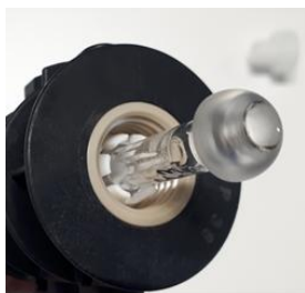
Figura 6 Iniettore inserito attraverso il corpo della torcia
