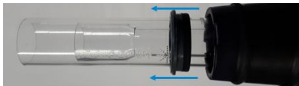
图 8 如果顶部密封垫与外管组一起移出，则将密封垫滑离炬管体，将其取下
