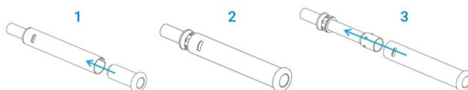
図11 セラミック製外側チューブセットの分解
