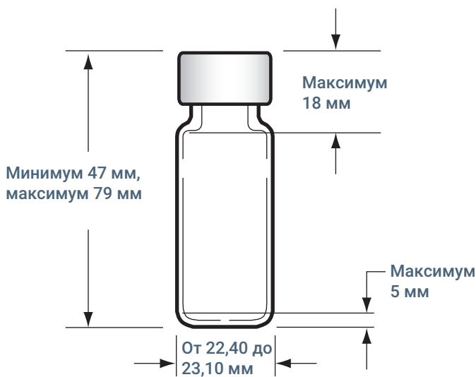
Рис. 7. Допустимые размеры виал
