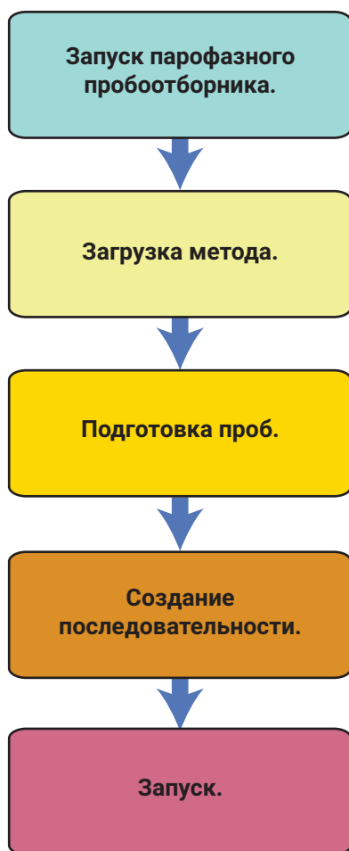
Рис. 5. Стандартная процедура парофазного анализа
