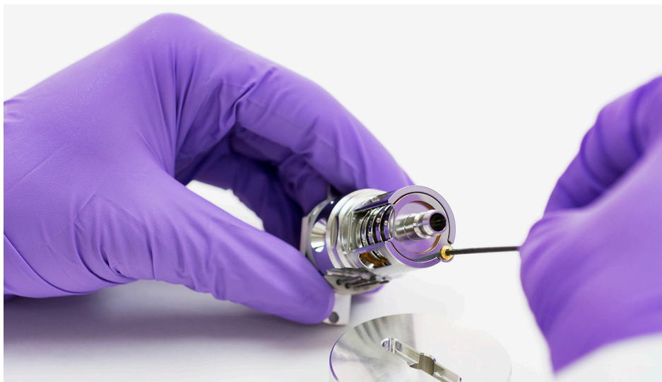
Figure 60. Fixer la vis de la lentille et l'isolant de l'anneau de verrouillage.
