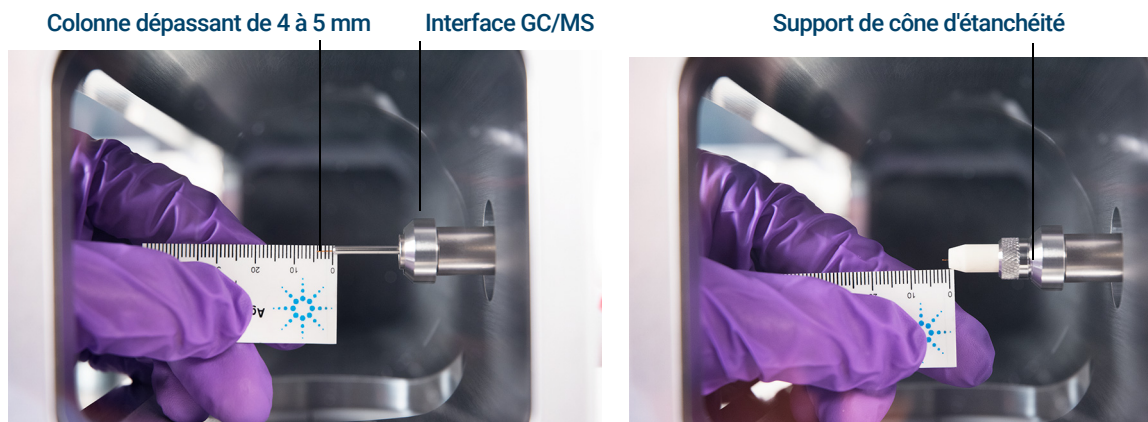
Figure 5. Installation d'une colonne capillaire dans l'interface GC/MS pour une source EI HES ou HES 2.0
