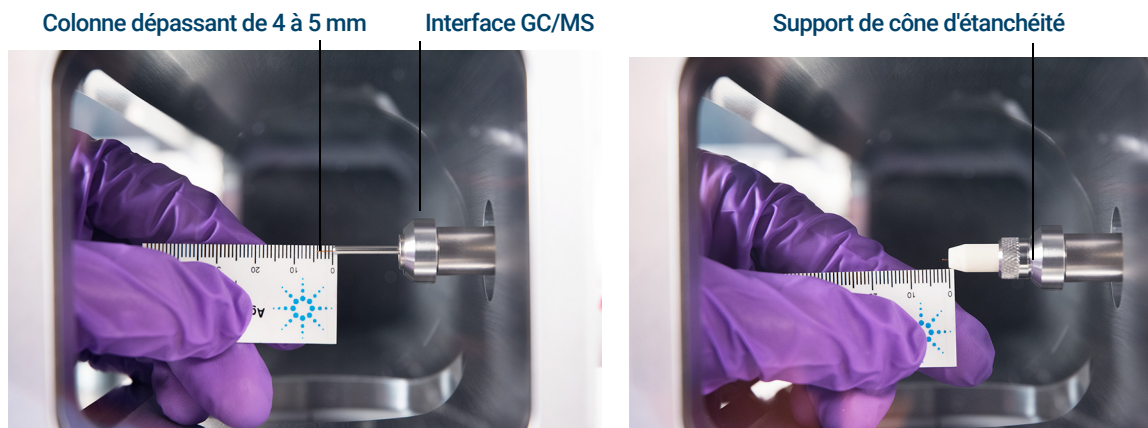
Figure 21. Installation d'une colonne capillaire dans l'interface GC/MS pour une source EI HES ou HES 2.0
