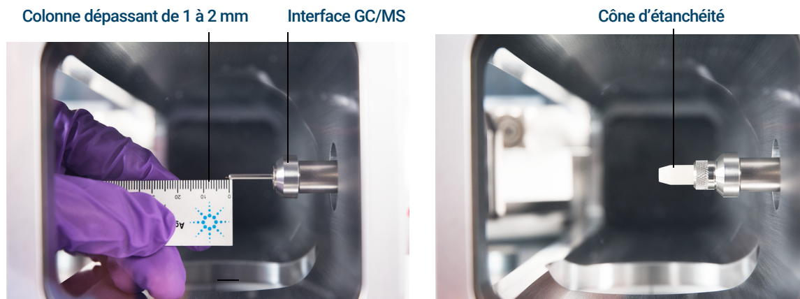
Figure 4. Installation d'une colonne capillaire dans l'interface GC/MS pour une source EI XTR ou une source CI
