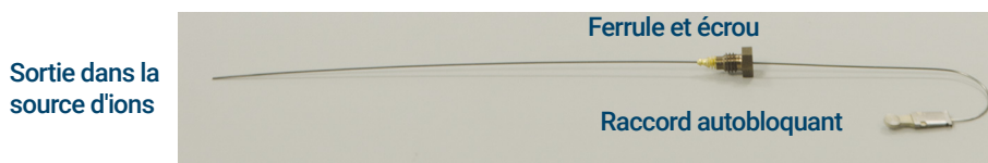
Figure 15. Extrémité du GC/MS 9000 retirée de l'interface GC/MS
