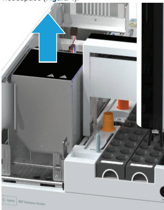
Figura 4. Levante o compartimento térmico da válvula em linha reta para cima
