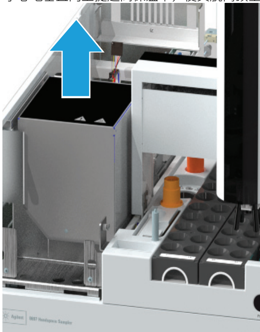
图 4. 垂直向上提起阀保温罩
