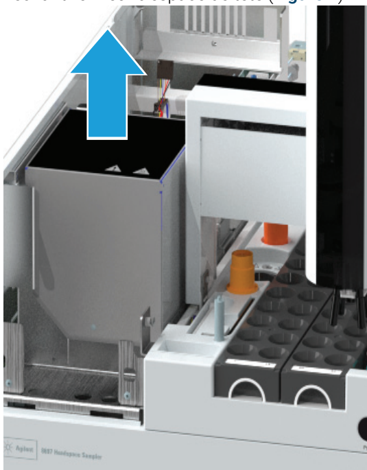
Figure 4. Soulever bien droit l'enceinte thermique de la vanne
