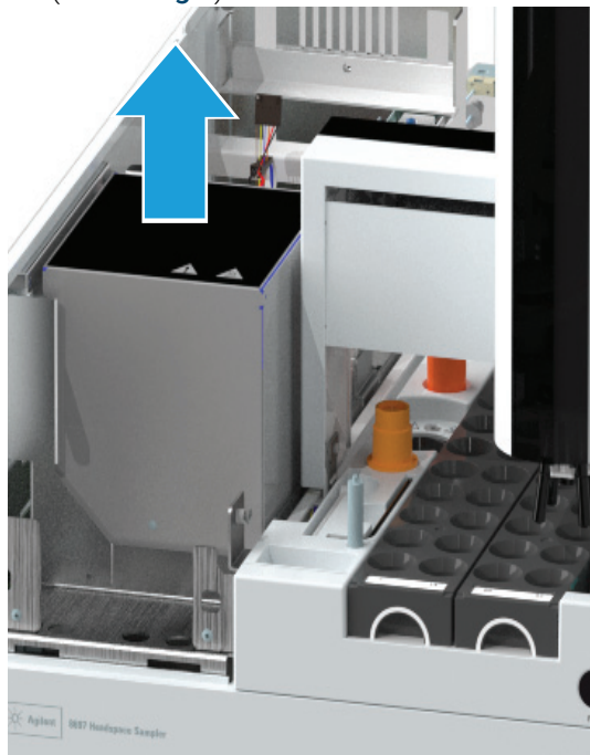
Abb.4. Heben Sie das Heizventilgehäuse senkrecht nach oben ab.
