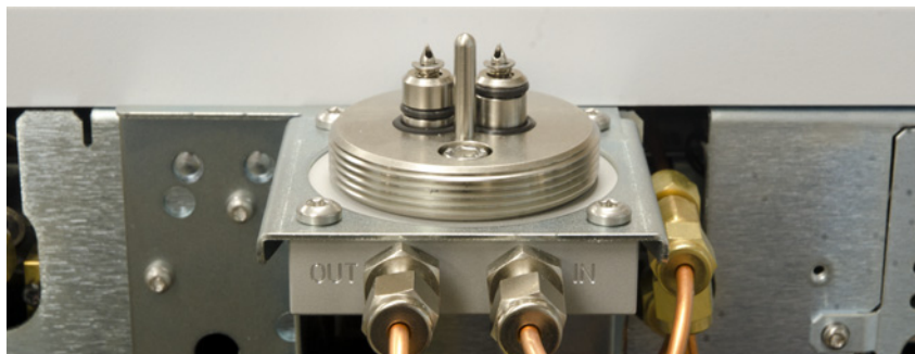
图 15. 支架连接单元安装在支架底部，用于 PAL 自动进样器配置
