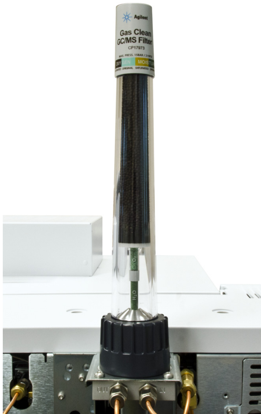
图 35. 安装到支架连接单元上的载气过滤器，所示为 7890
