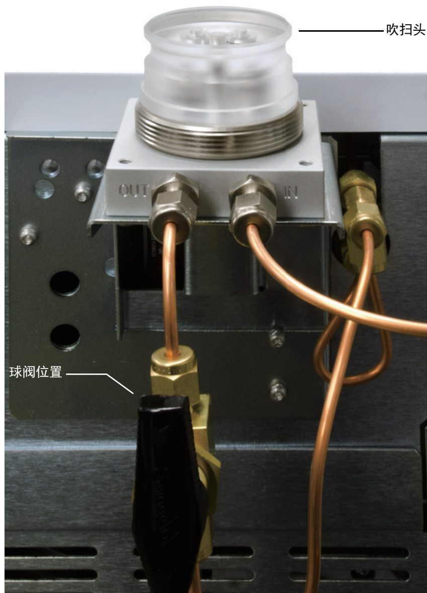
图 31. 使用吹扫头吹扫气体管线中的氧气和水分（所示为 7890 安装）
