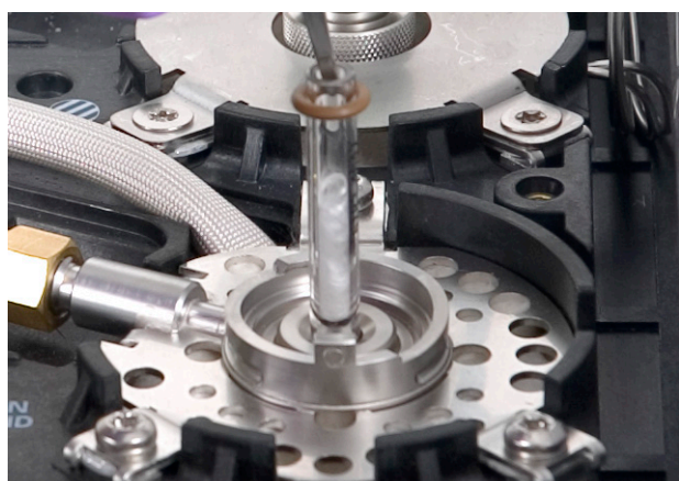
6 ゴールドシールの表面にグラファイトやセプタムの汚染がないか確認します。必要に応じて、ゴールドシールを交換します (51 ページの「スプリット/スプリットレス注入口のゴールドシールを交換する」を参照)。
