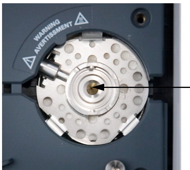
6 ゴールドシールの表面にグラファイトやセプタムの汚染がないか確認します。必要に応じて、ゴールドシールを交換します (51 ページの「スプリット/スプリットレス注入口のゴールドシールを交換する」を参照)。
