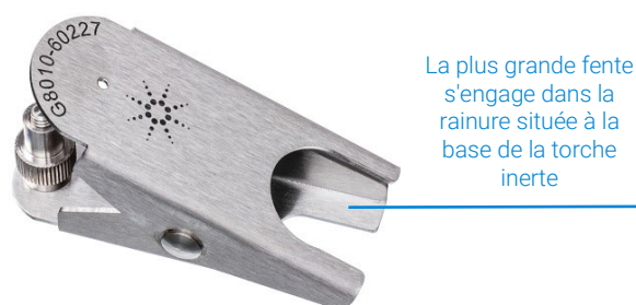
Figure 3b. Pince recommandée pour une utilisation avec la torche inerte de MP-AES.
