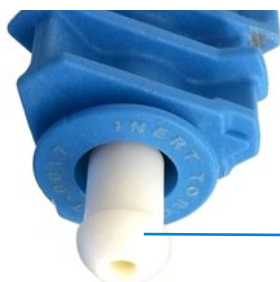
Figure 2. Embout hémisphérique en PTFE attaché au tube d'injecteur.
