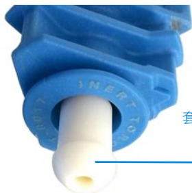
图 2. 与进样器管连接的 PTFE 球形接头
