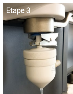
Figure 4. Installation de la chambre de nébulisation inerte sur la torche inerte de MP-AES.
