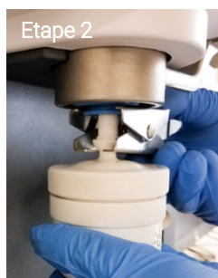
Figure 4. Installation de la chambre de nébulisation inerte sur la torche inerte de MP-AES.
