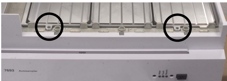
图 48 安装两个 T-20 Torx 螺丝以固定 Peltier 模块前端
