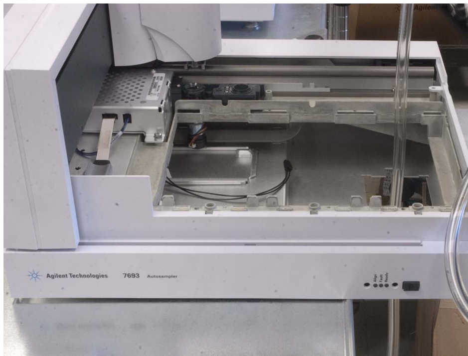
图 44 将排水管穿过附件开口
