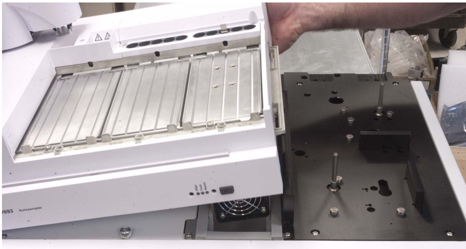
图 54 将样品盘向下放入主机机箱上
