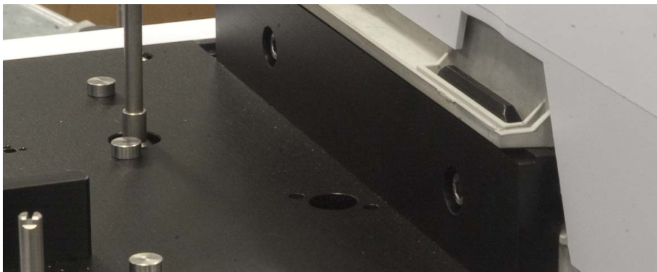
图 26 卸下主机安装支架上的螺丝
