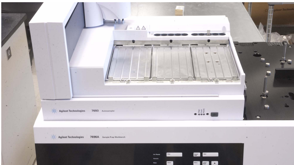
图 55 包含 Peltier 模块的样品盘平稳地放在主机表面上
