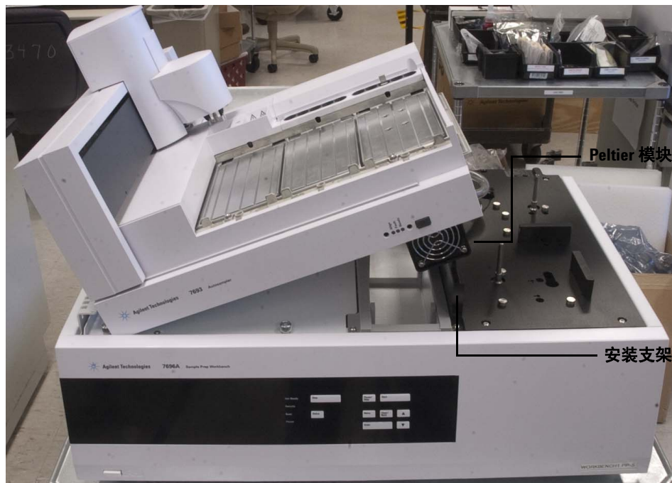
图 52 将样品盘放在主机上，使 Peltier 模块位于安装支架上
