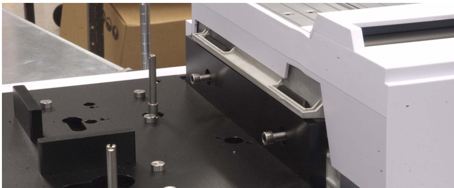
图 57 将样品盘固定到主机安装支架上
