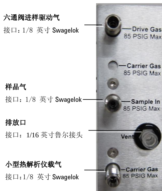
图 7 G4370M 后面板接头
