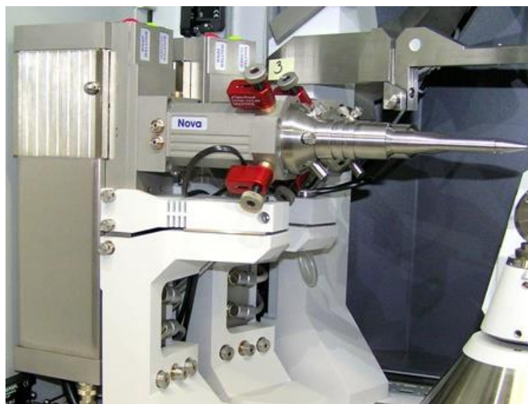
Abbildung 11 Microfocus-Röntgenquelle auf dem SuperNova-Diffraktometer montiert
