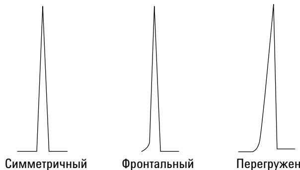
Если возникает фронтальный или перегруженный пик, попробуйте выполнить следующие действия.
