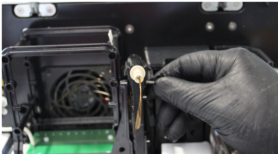
Afbeelding 59 Bovenste compartiment van het instrument: het venster van de Capillary Array bevestigen aan het frame van de Capillary Array
