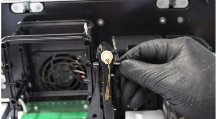
Afbeelding 69 Bovenste compartiment van het instrument: de bevestigingsschroef van de Capillary Array
