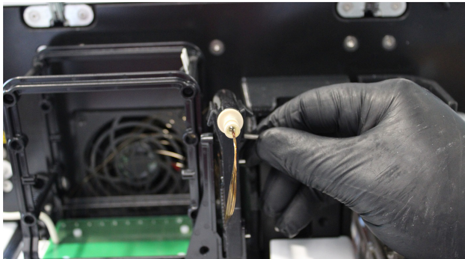
Figura 59 Comparto superiore dello strumento – fissare la finestra dell'array alla struttura del capillary array
