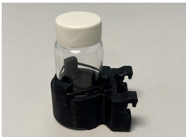
Figura 103 Dispositivo di conservazione dell'array con mandrino; in questo flacone di esempio non è presente soluzione di conservazione
