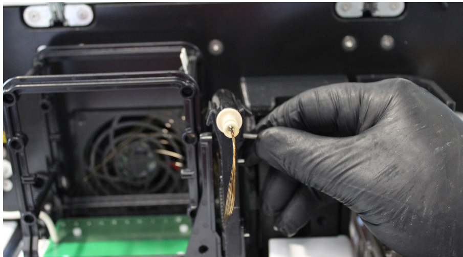
Figure 59 Compartiment supérieur de l'instrument – fixer la fenêtre de l'array au cadre du capillary array
