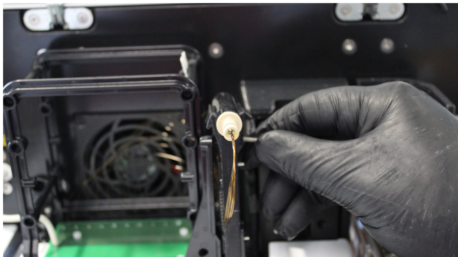
Figura 69 Compartimento superior del instrumento: tornillo de fijación de la ventana del microarray
