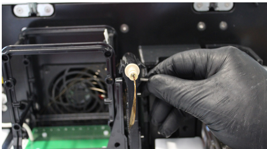
Abbildung 59 Oberes Gerätefach – Array-Fenster am Rahmen des Capillary Array befestigen
