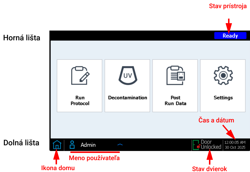
Obrázok 32 Znáznornenie prvkov na hornej a dolnej lište
