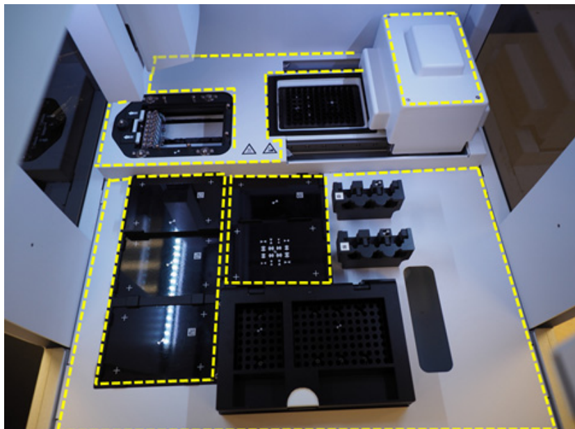
Obrázok 27 Povrchy plošiny, ktoré treba utrieť
