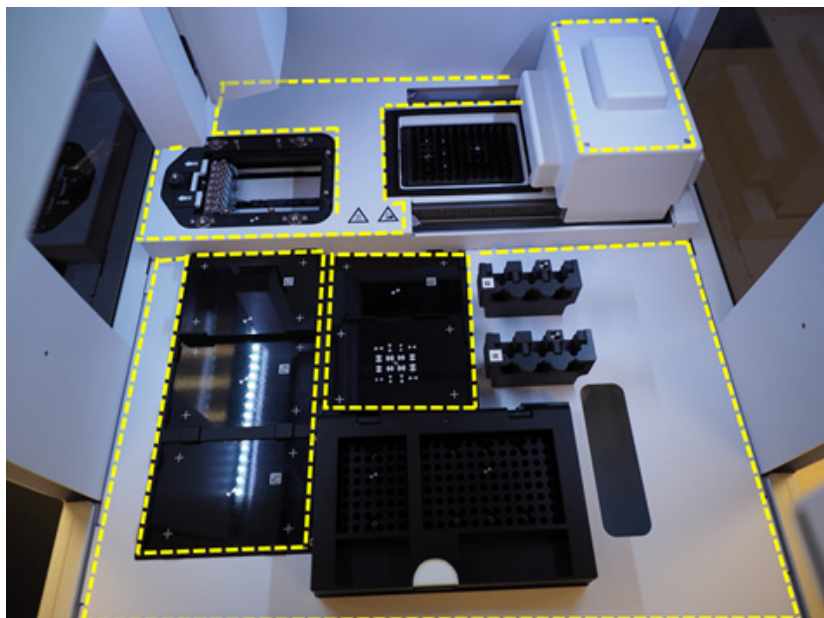
Figura 27 Superfícies da plataforma a limpar
