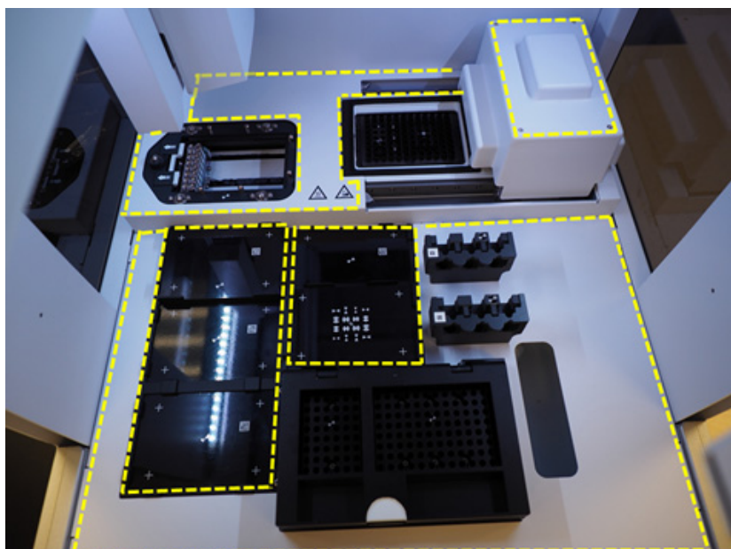
Figur 27 Dækkets overflader skal tørres af
