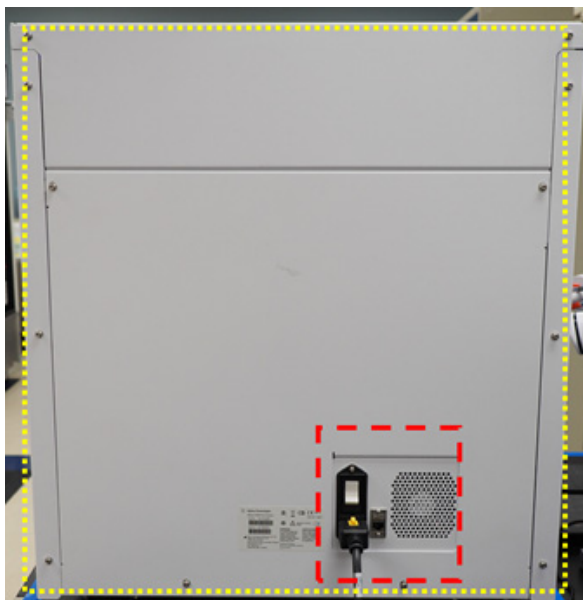
Obrázek 30 Vnější povrchy na zadní straně přístroje, které je třeba otřít
