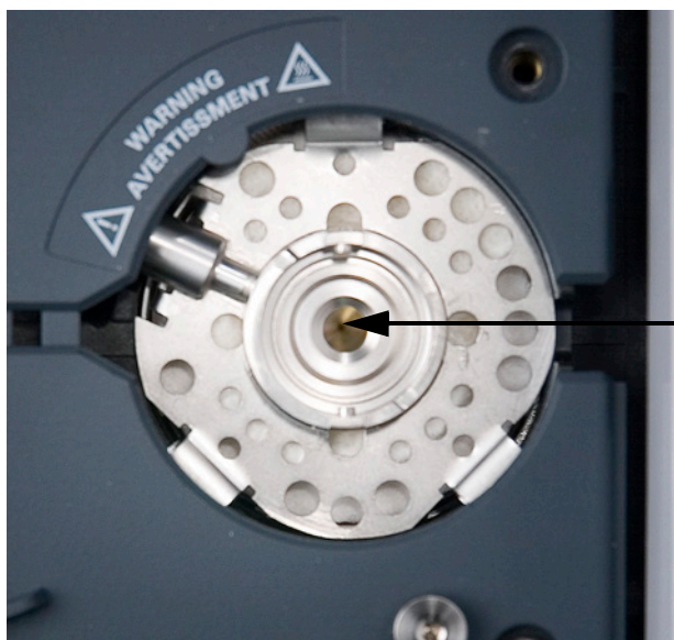
6 シールの表面に汚染がないか確認します。必要に応じて、綿棒を使用してクリーニングします。
