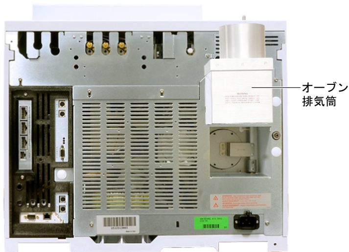
図 3 オープン排気筒の正しい位置
