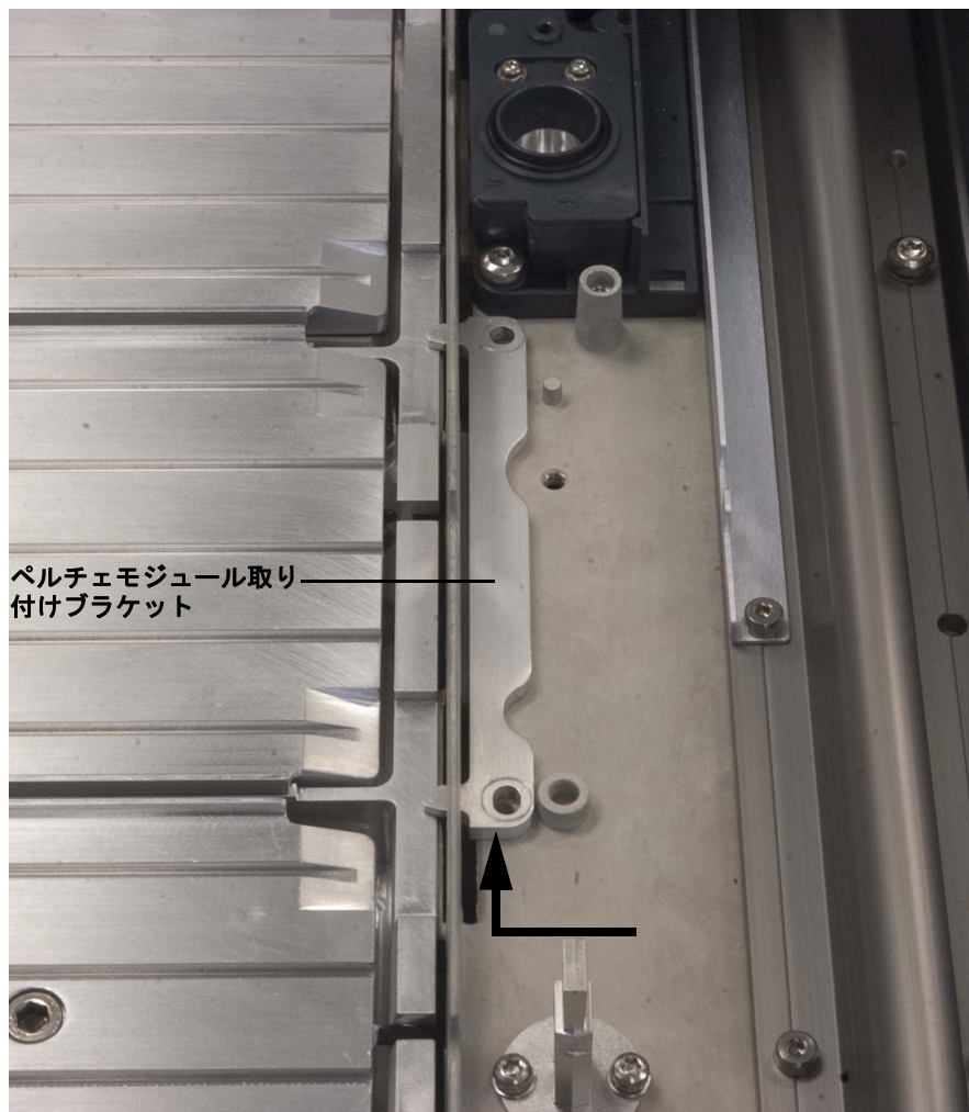
図 49 ペルチェモジュール取り付けブラケットを取り付ける
