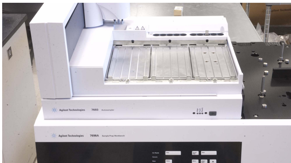
図 55 メインフレーム表面上に均等に配置したパルチェモジュール付きサンプルトレイ
