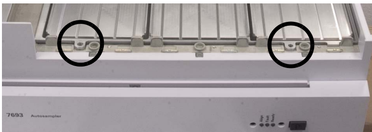
図 48 2 本の T-20 トルクスネジを取り付けて、ペルチェモジュール前面を固定する
