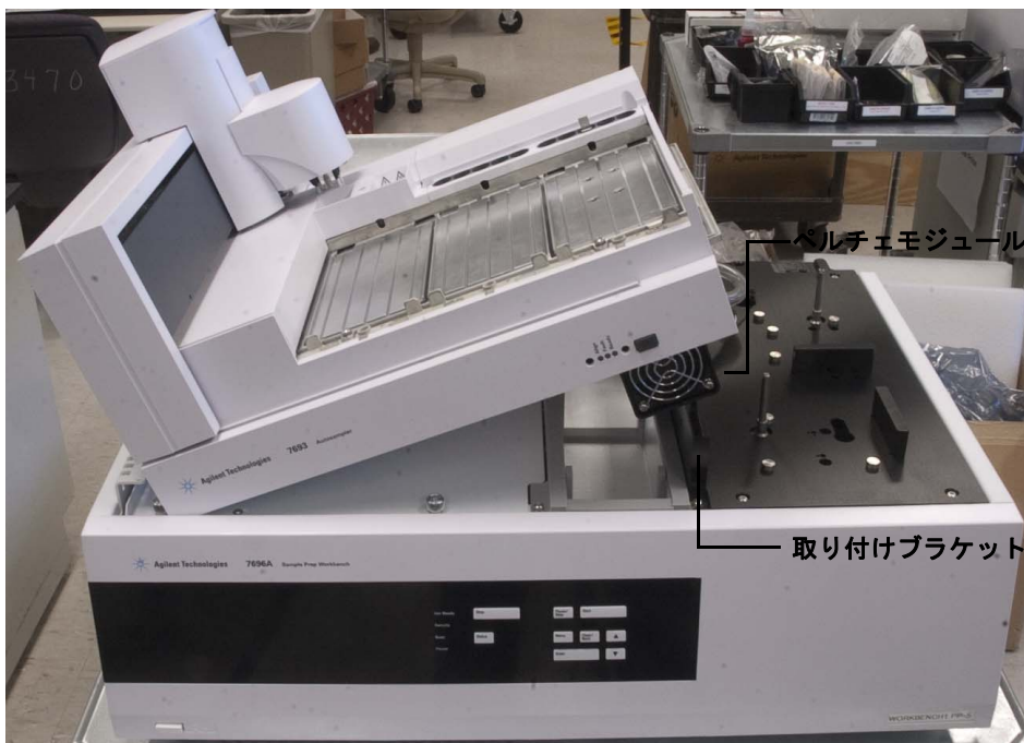
図 52 ペルチェモジュールが取り付けブラケット上に来るように、サンプルトレイをメインフレーム上で支える
