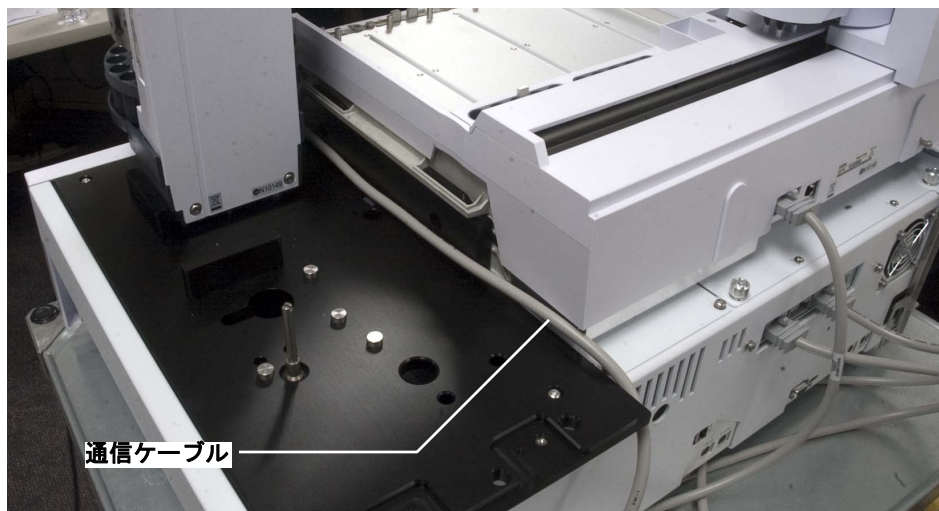
図 21 フロントタワーのケーブルをサンプルトレイ取り付けブラケットに配線
