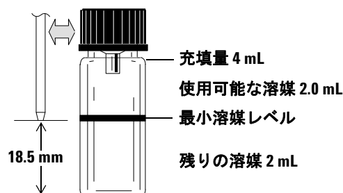
図 88 溶媒を吸引するときのニードル先端の位置
