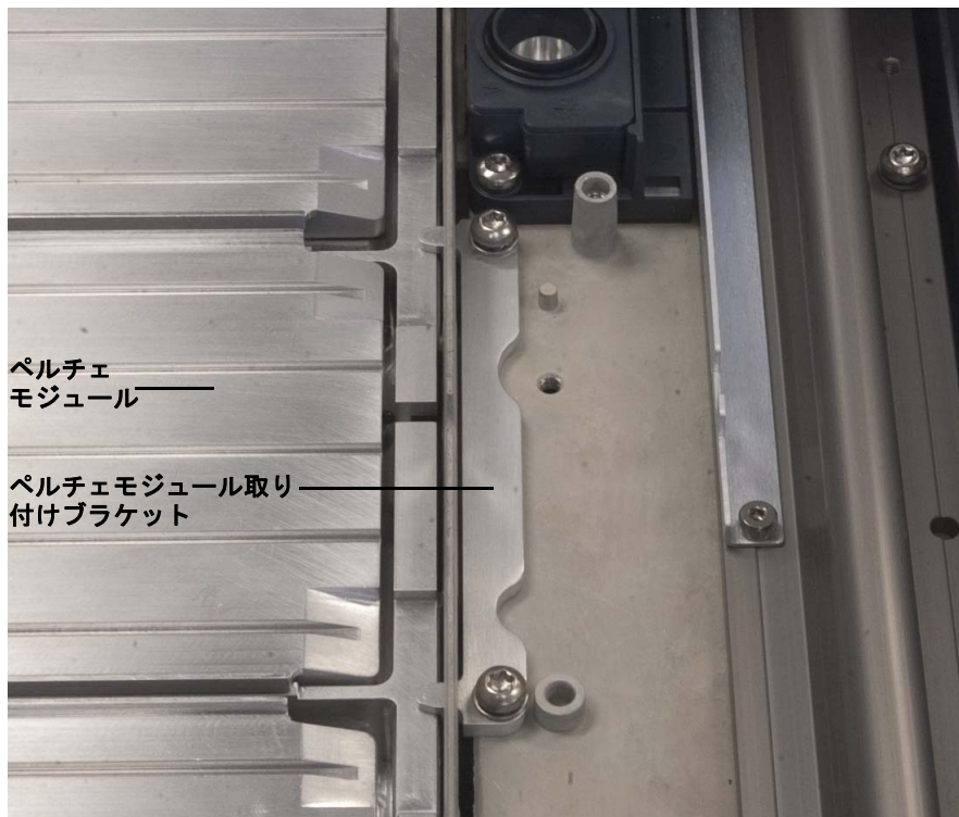
図 50 ペルチェモジュールとペルチェモジュール取り付けブラケットを固定する
