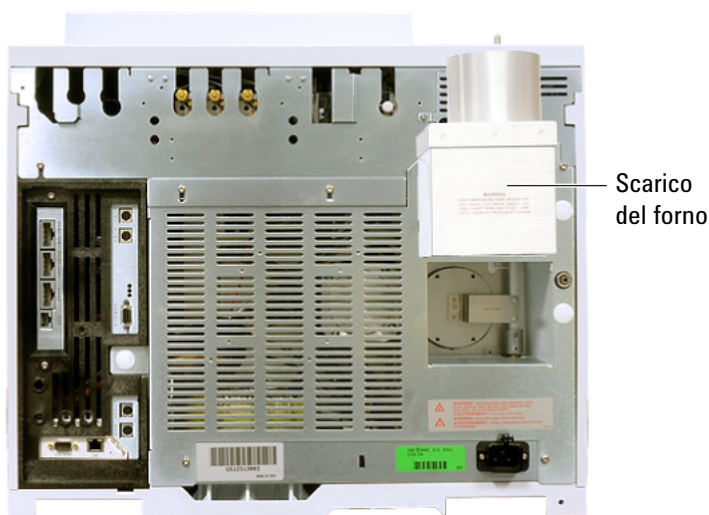
Figura 3 Posizione corretta del deflettore di scarico del forno
