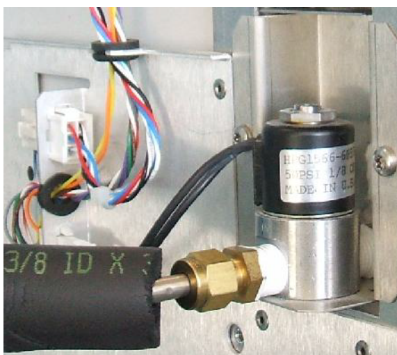
Figura 15 Collegamenti delle valvole di raffreddamento criogenico con N 2
