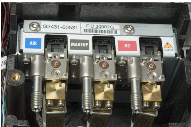
Figura 11 Modulo di flusso per il rivelatore
