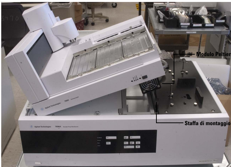
Figura 52 Sistemazione del vassoio per campioni sull'unità principale con parte inferiore del modulo Peltier alloggiata sulla staffa di montaggio
