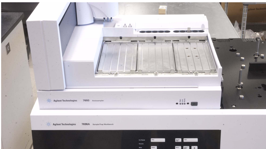
Figura 55 Vassoio per campioni con modulo Peltier in posizione corretta sulla superficie dell'unità principale
