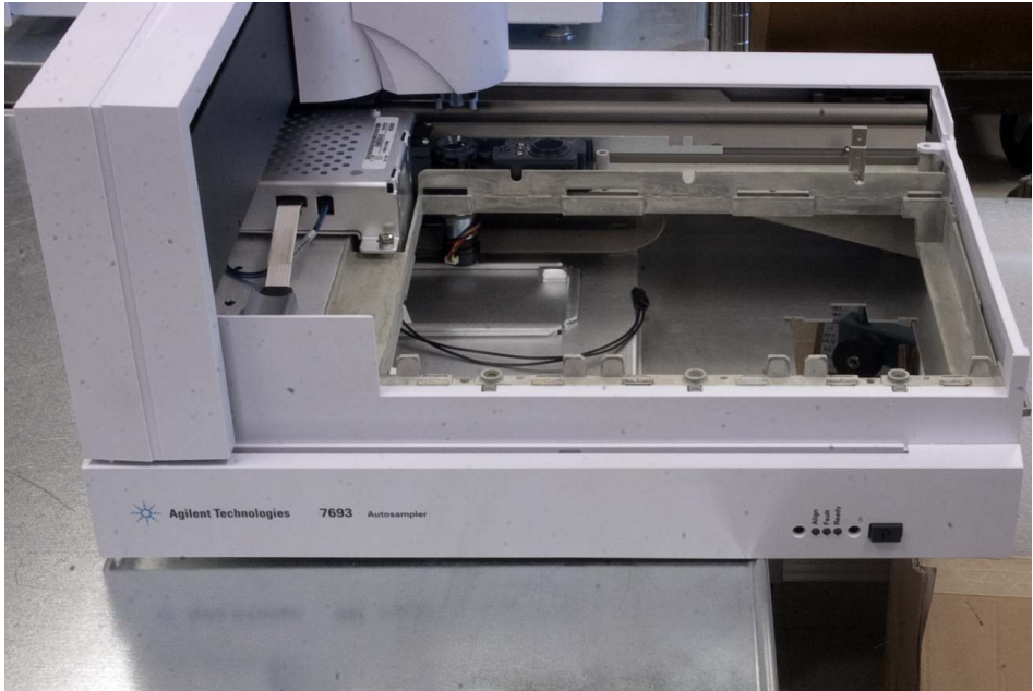
Figura 38 Alloggiamento del vassoio per campioni in prossimità del bordo di un bancone o di un tavolo
