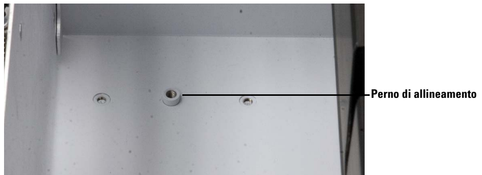
Figura 29 Perno di allineamento all'interno dello chassis dell'unità principale
