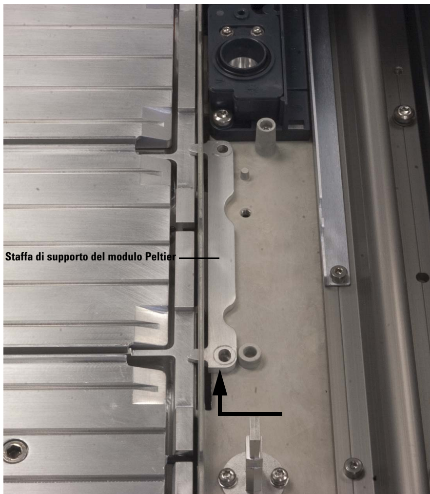
Figura 49 Installazione della staffa di supporto del modulo Peltier
