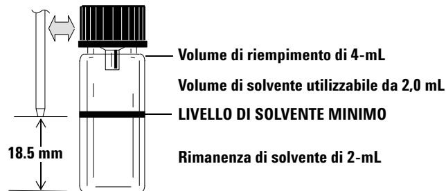
Figura 88 Posizione della punta dell'ago durante il prelievo di solvente
