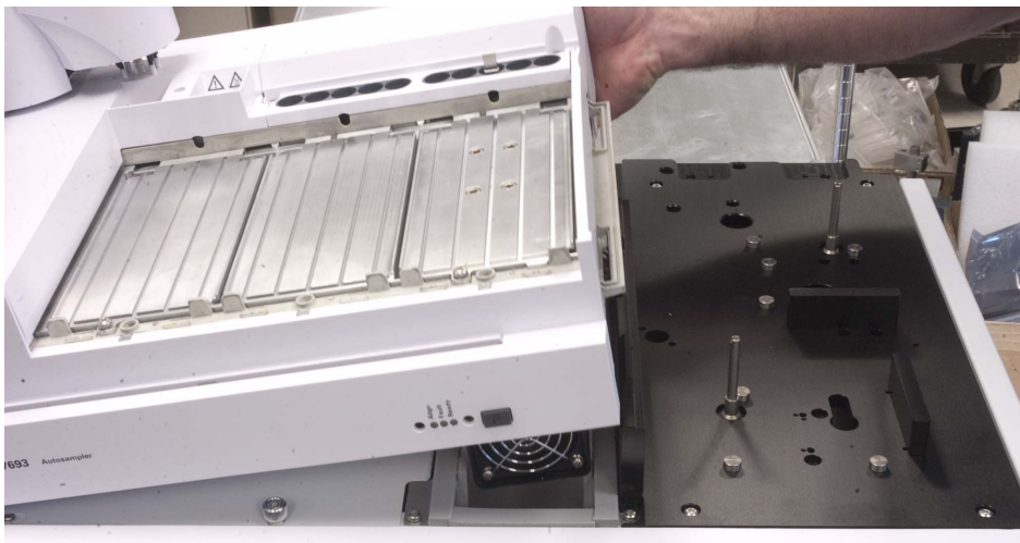
Figura 54 Abbassamento del vassoio per campioni sullo chassis dell'unità principale
