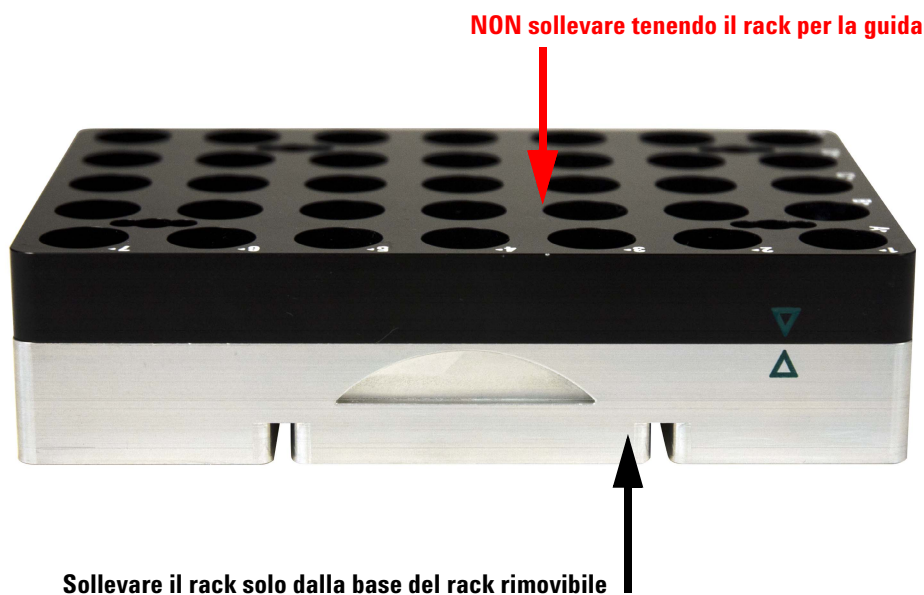
Figura 68 Sollevamento del rack per fiale rimovibile con la guida
