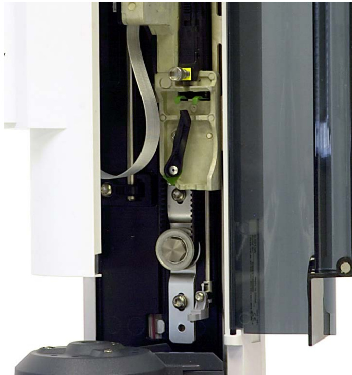
Figura 17 Morsetto di imballaggio rimosso
