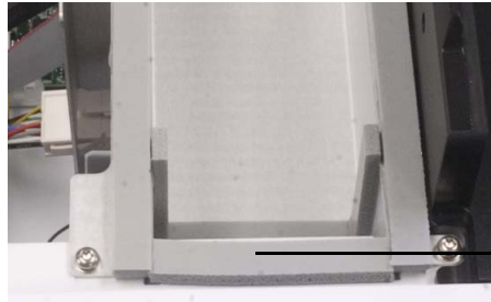
Figura 35 Adesivo in schiuma adesiva sullo chassis dell'unità principale
