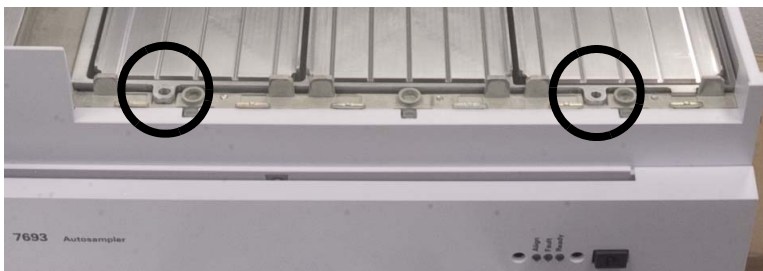
Figura 48 Fissaggio di due viti torsiometriche T-20 per fissare il pannello anteriore del modulo Peltier
