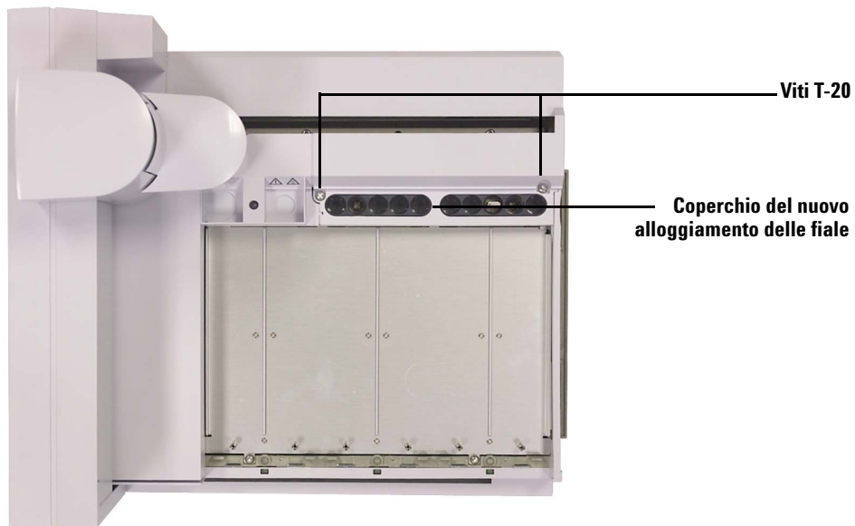
Figura 39 Rimozione delle viti e coperchio del nuovo alloggiamento delle fiale
