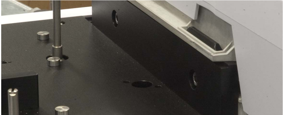
Figura 26 Rimozione delle viti sulla staffa di montaggio dell'unità principale
