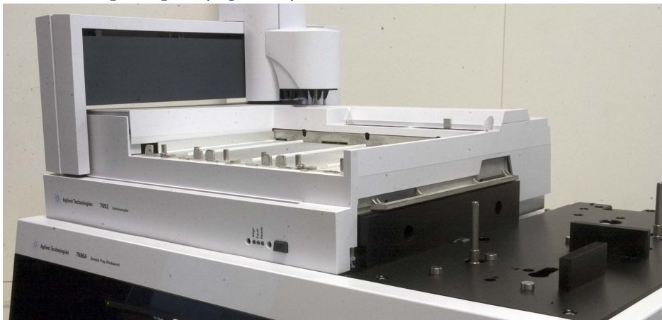
Figura 13 Vassoio per campioni in posizione piana sulla base dell'unità principale
