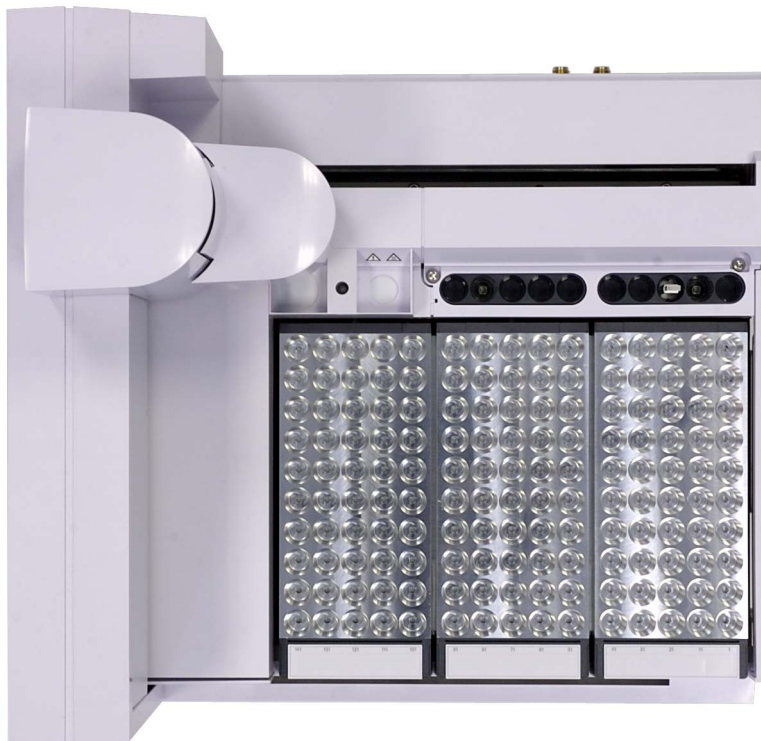
Figura 58 Rack per fiale del modulo Peltier installati
