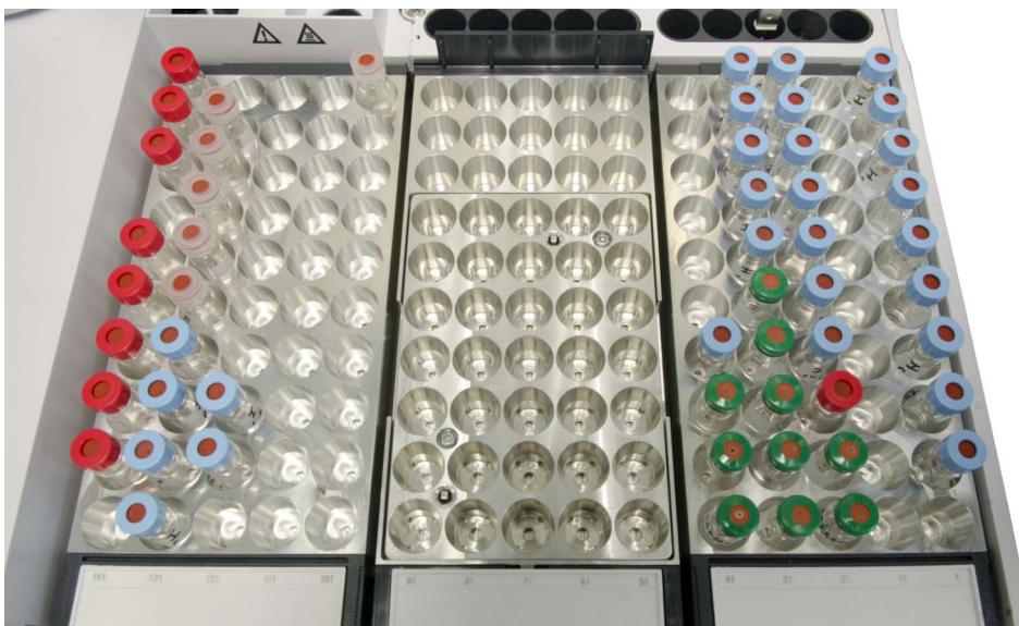
Figura 66 Rack per fiale LC installato in posizione centrale
