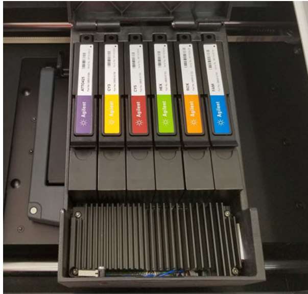
Abbildung 10 Installierte optische Module
