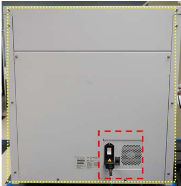
图 35 要擦拭的仪器背面的外表面
