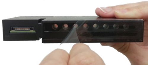
图 9 从光学模块上取下塑料薄膜
