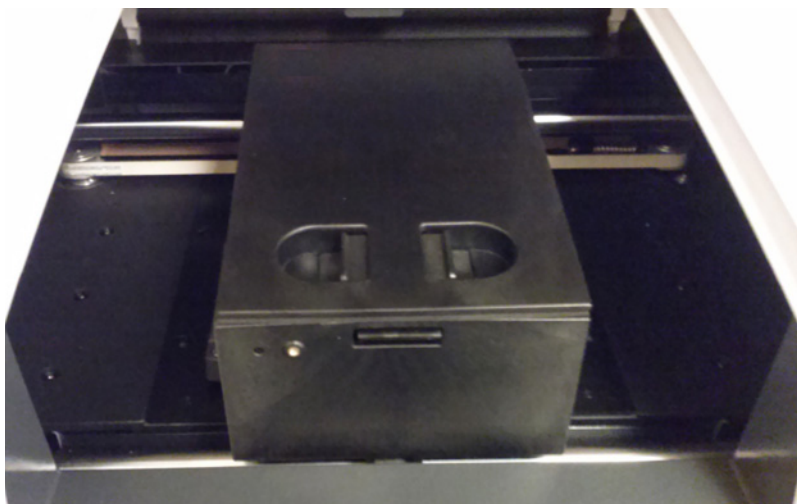
图 5 光学模块外壳托架，对准仪器门开口。
