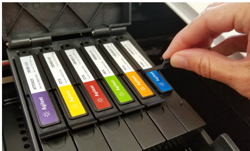
图 50 提起光学模块上的铰接片
