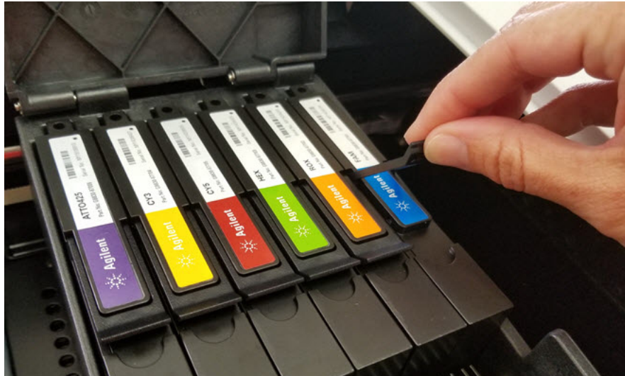
Figure 50 Soulever la languette à charnière d'un module optique
