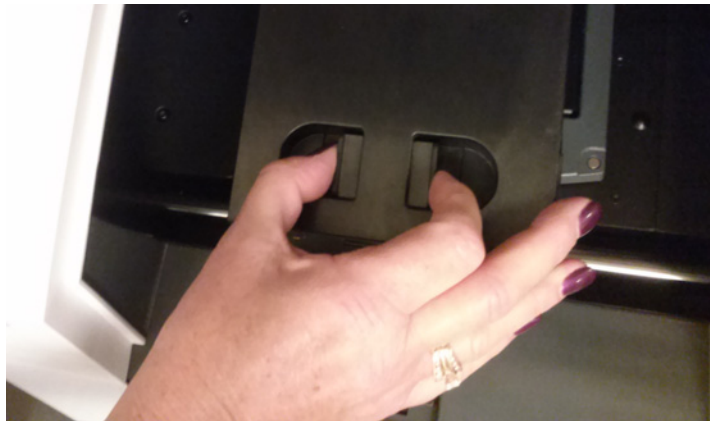
Figure 6 Ouverture du boîtier du module optique
