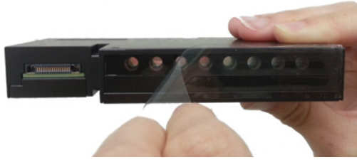
Figure 9 Retrait du film plastique d'un module optique
